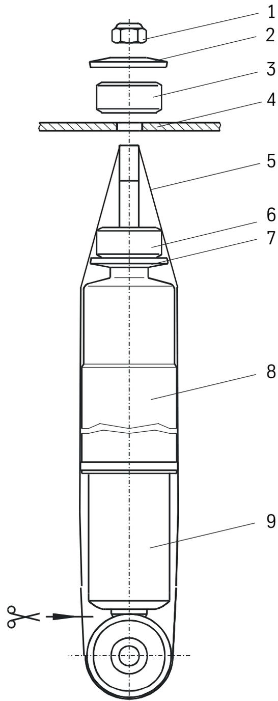
**Das Spannband nicht vor dem Einbau des BILSTEIN Stoßdämpfers entfernen, es dient als Montageband!**
