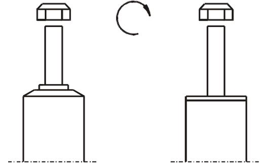
Um eine mögliche Zerstörung des Produktes zu vermeiden, darf zum Lösen und Anziehen der Muttern kein Schlagschraubendreher verwendet werden.
