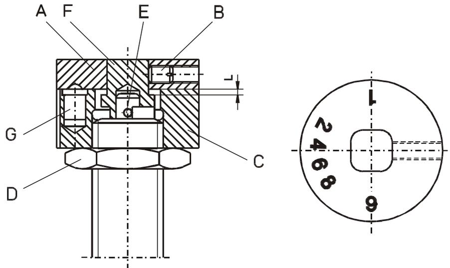
Verstellposition **9** = **weich** (im Uhrzeigersinn drehen)
