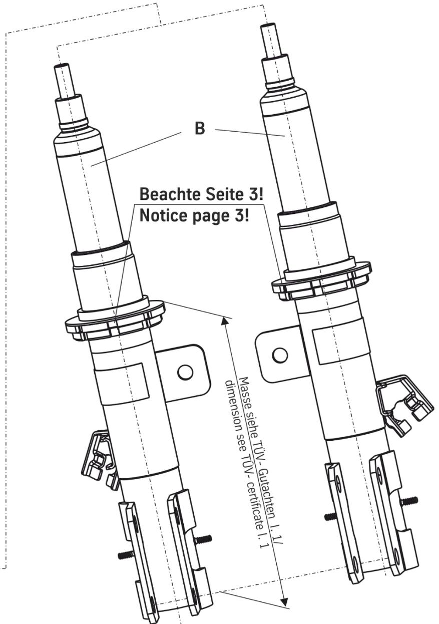
Original ABS- Halteclips entfernen und ABS-Kabel mit den im Lieferumfang enthaltenen Haltern (Bild 1) spannungsfrei verlegen.
