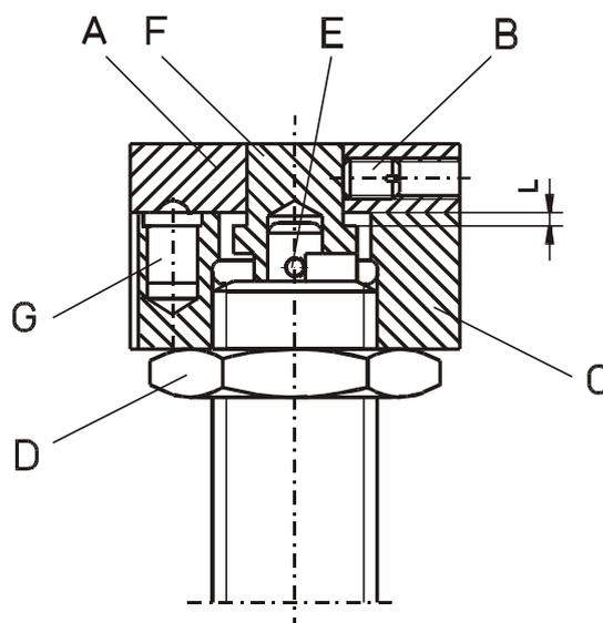
Verstellposition **9** = **weich** (im Uhrzeigersinn drehen)
