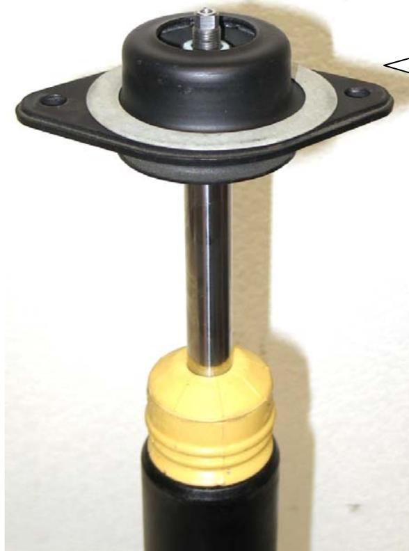
Original Stützlager aufstecken und mit der mitgelieferten Muttern verschrauben. Das Anzugsdrehmoment der Kolbenstangenbefestigung beträgt 20 Nm. Die Montagehinweise zum Einbau des Dämpfers in das Fahrzeug, sowie die Anzugsdrehmomente der Federbeinbefestigung, entnehmen Sie bitte den Unterlagen des Fahrzeugherstellers.
