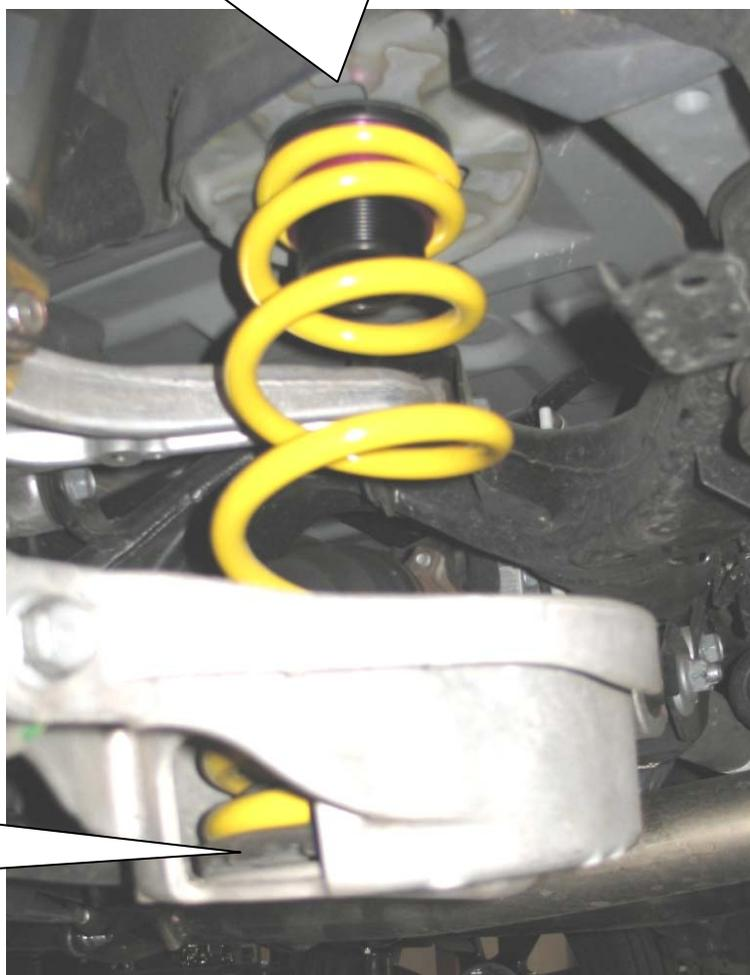
Am unteren Ende der Feder wird die Original Federunterlage weiterverwendet.
