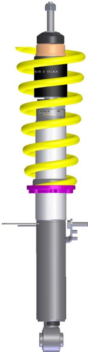
Original Stützlager ohne Original Anschlagelament aufstecken und mit der mitgelieferten Stopmutter verschrauben. Das Anzugsdrehmoment der Kolbenstangenbefestigung beträgt 35 Nm. Die Montagehinweise zum Einbau des Federbeines in das Fahrzeug, sowie die Anzugsdrehmomente der Federbeinbefestigung, entnehmen Sie bitte den Unterlagen des Fahrzeugherstellers.
