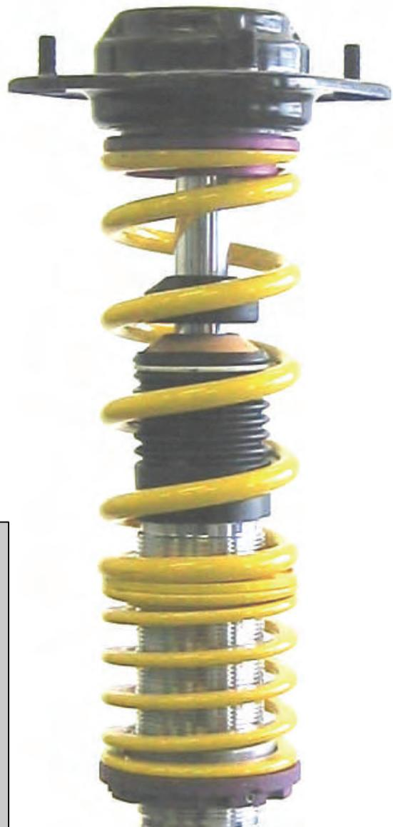
Nach erfolgtem Einbau des Fahrwerkes ist die Freigängigkeit der Bereifung zum VA Federbein zu überprüfen. Das Mindestabstandsmaß an der engsten Stelle darf **5 mm** nicht unterschreiten und ist gegebenenfalls mittels handelsüblicher, TÜV geprüfter Distanzscheiben wieder herzustellen.
