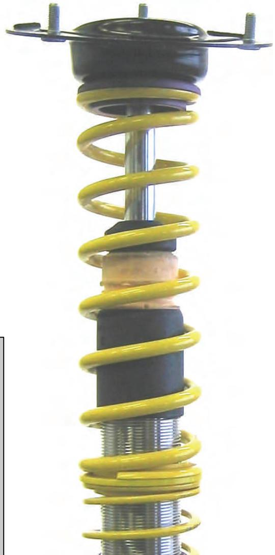
Nach erfolgtem Einbau des Fahrwerkes ist die Freigängigkeit der Bereifung zum HA Federbein zu überprüfen. Das Mindestabstandsmaß an der engsten Stelle darf **5 mm** nicht unterschreiten und ist gegebenenfalls mittels handelsüblicher, TÜV geprüfter Distanzscheiben wieder herzustellen.
