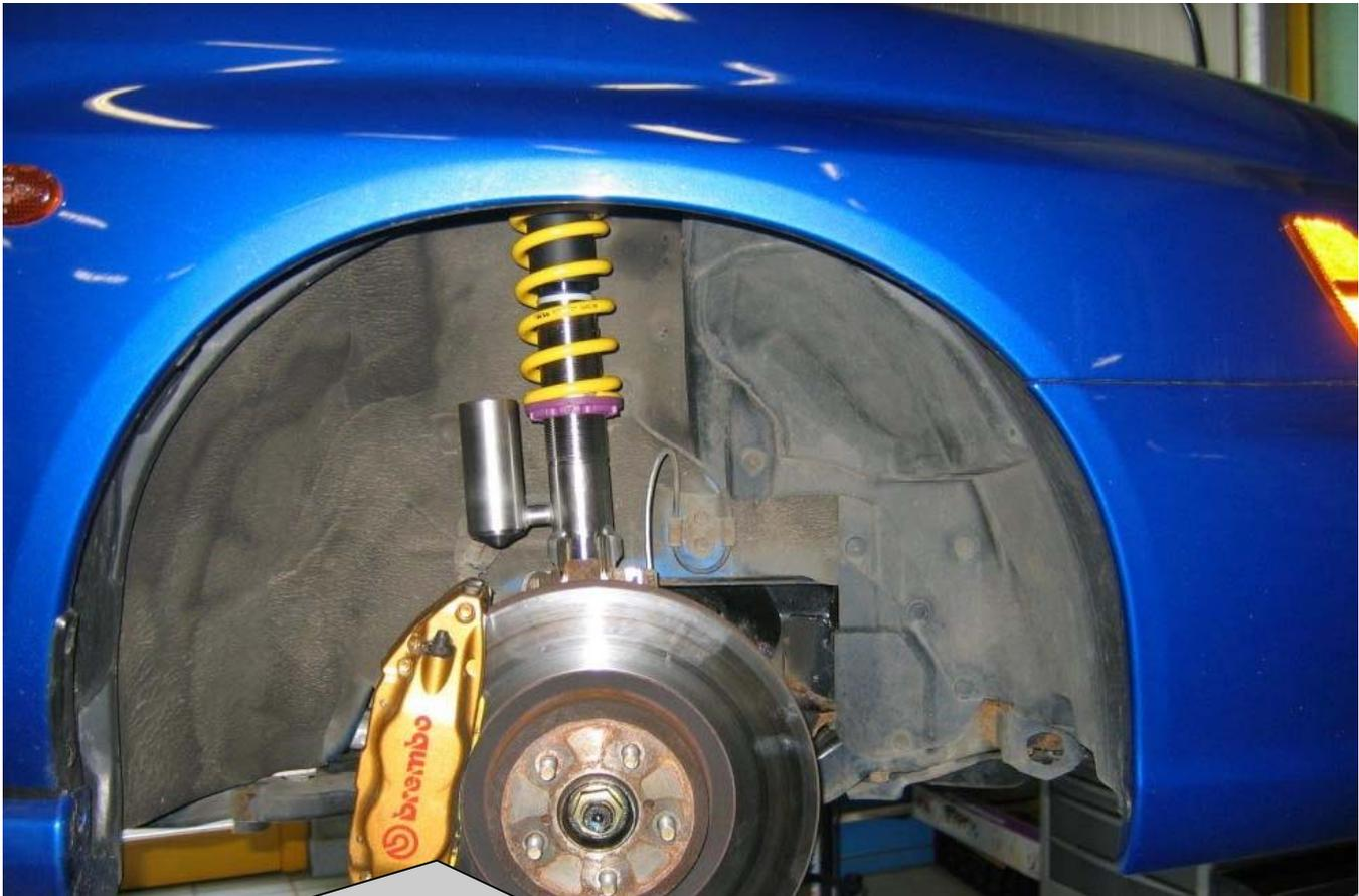
Bei Dämpferausführungen mit Druckausgleichsbehälter ist dieser, wie auf dem Bild zu sehen, zur Fahrzeugheckseite zu montieren.
