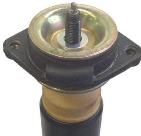
Original Stützlager mit der mitgelieferten Mutter verschrauben. Das Anzugsdrehmoment der Kolbenstangenbefestigung beträgt 40 Nm. Den Einbau des Dämpfers in das Fahrzeug, sowie die Anzugsdrehmomente der Dämpferbefestigung, entnehmen Sie bitte den Unterlagen des Fahrzeugherstellers.
