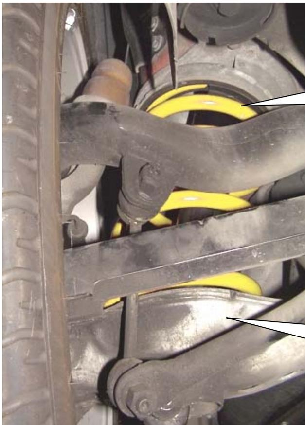
Am oberen Ende der Feder wird das Original Gummielement weiterverwendet.
