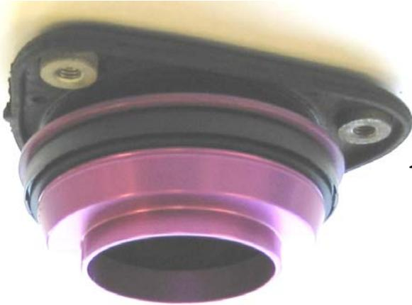
Original Axiallager aus dem serienmäßigen Stützlager entnehmen. Mitgelieferten Axiallagersatz in folgender Reihenfolge auf das Stützlager aufsetzen (siehe Bild): Serienstützlager; Kunststoffscheibe; mitgeliefertes Axiallager; Federteller.
