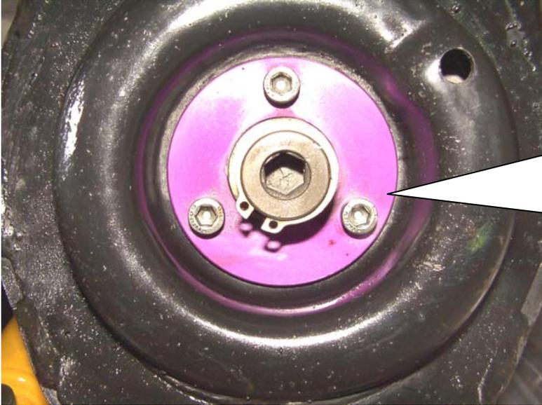
An der angelieferten HA Verstellung die Befestigungsplatte, durch entfernen der drei Befestigungsschrauben und des Sicherungsring, demontieren. Höhenverstellung von oben in den Querlenker einsetzen und verschrauben (siehe Bild). Anzugsdrehmoment beträgt: 10 Nm.
