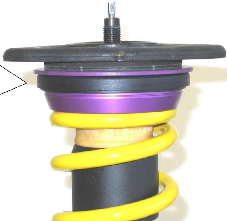
Nach erfolgreichem Einbau des Fahrwerkes ist die Freigängigkeit der Bereifung zum VA Federbein zu überprüfen. Das Mindestabstandsmaß an der engsten Stelle darf **5 mm** nicht unterschreiten und ist gegebenenfalls mittels handelsüblicher, TÜV geprüfter Distanzscheiben wieder herzustellen.
