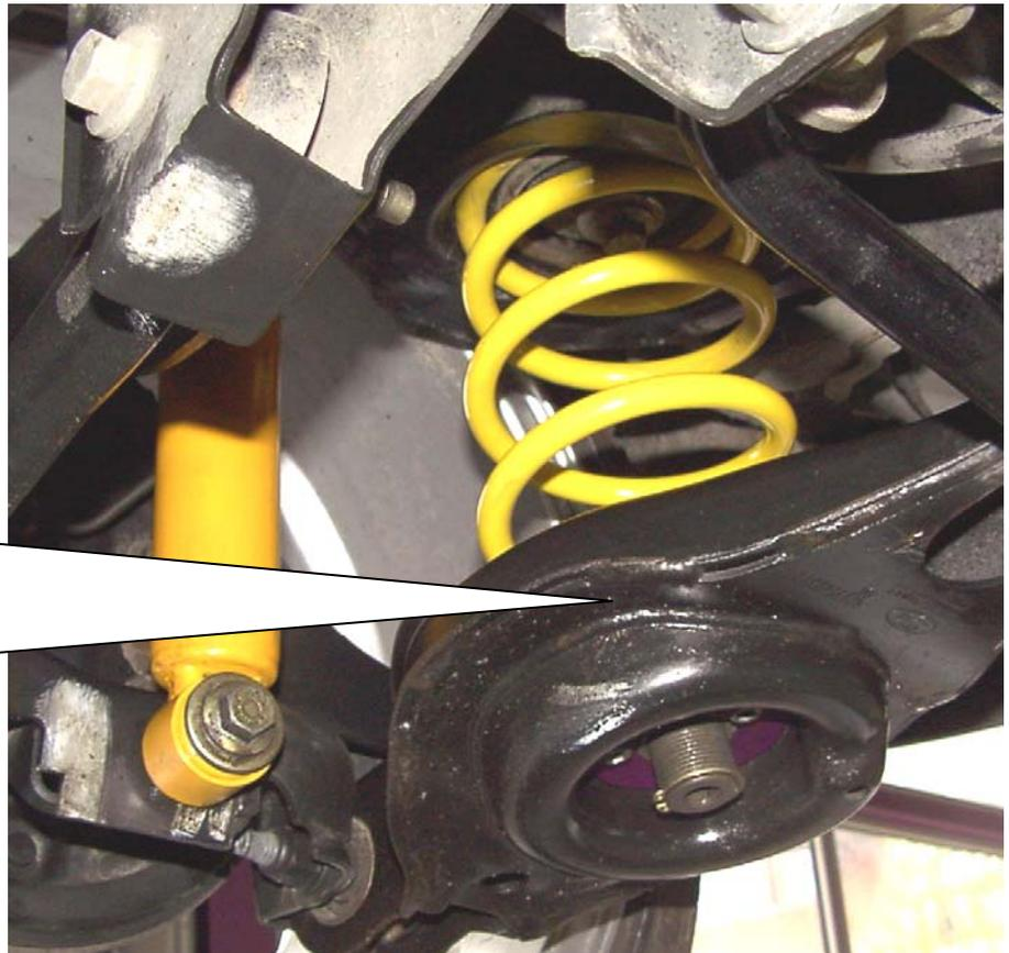
Feder mit der geschliffenen Seite unten, gegen die Höhenverstellung einsetzen. Zwischen Feder und Höhenverstellung wird die mitgelieferte Gleitscheibe eingelegt. Zum Korrigieren der Fahrzeughöhe ist die Feder zu entlasten oder gegebenenfalls zu demontieren.
