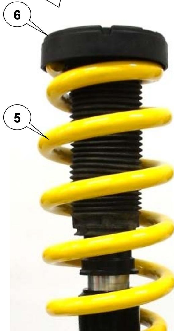
Kennzeichnung „R“ für rechte Seite „L“ für linke Seite! Der Dämpfer muss wieder so montiert werden, dass die Ventiltechnik in Richtung Fahrzeugvorderseite zeigt.
