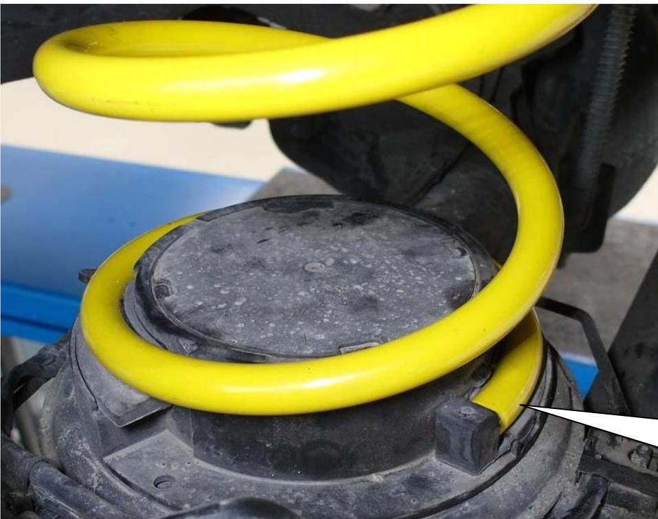
Am unteren Ende der Feder wird die originale Federunterlage weiterverwendet.
