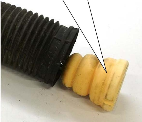
Mitgeliefertes Anschlagelement auf den Dämpfer aufstecken. Das Serienanschlageelement wird nicht länger benötigt und muss demontiert werden.
