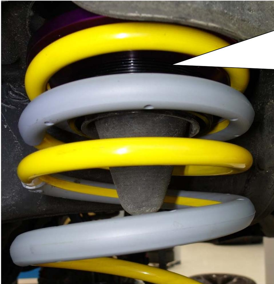
Die HA-Verstellung wird oben zwischen Feder und Karosserie montiert. Die serienmäßige Federunterlage entfällt. Zum Korrigieren (verdrehen des Gewinderings) der Fahrzeughöhe, ist die HA-Verstellung aus dem Fahrzeug zu demontieren.
