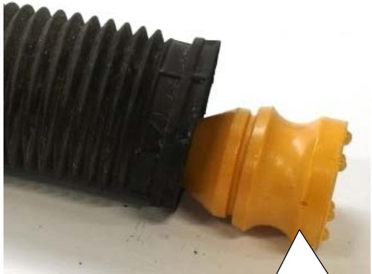
Mitgeliefertes Anschlagelement montieren
