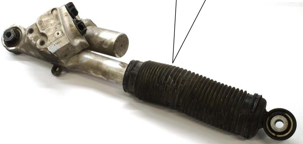
Staubschutz und Anschlagelament nach unten ziehen und die mitgelieferte Kolbenstangenklemmung am Dämpfer montieren. Anschließend das obere Dämpferauge abschrauben.
