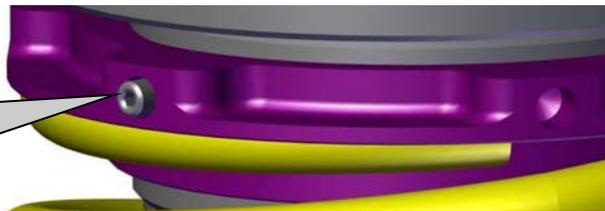
Eine Höheneinstellung über die Gewindehülse ist nur im ausgebauten Zustand möglich. Hierbei wird von der Auflagefläche im Stützlager zur Federauflage gemessen.
