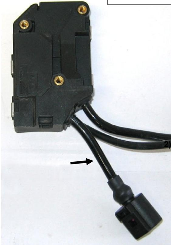
2. 15 mm von der Ummantelung der Leitung entfernen und die Adern 4 - 5 mm abisolieren. Anschließend den mitgelieferter Schrumpfschlauch auf die Leitung aufstecken.
