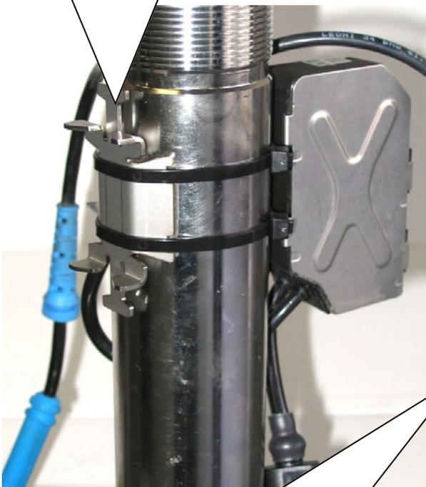
Stilllegung an der Edelstahlhalterung mit Kabelbinder 4,8mm x 290mm befestigen. Zusätzlich muss die Steckverbindung mit einem Kabelbinder am Originalsteuergerät befestigt werden.
