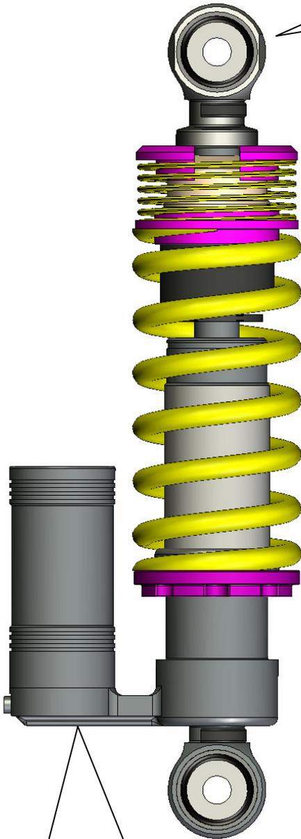
Bei Dämpferausführungen mit Druckausgleichsbehälter ist dieser, wie auf dem Bild zu sehen, zur Fahrzeuginnenseite zu montieren.
