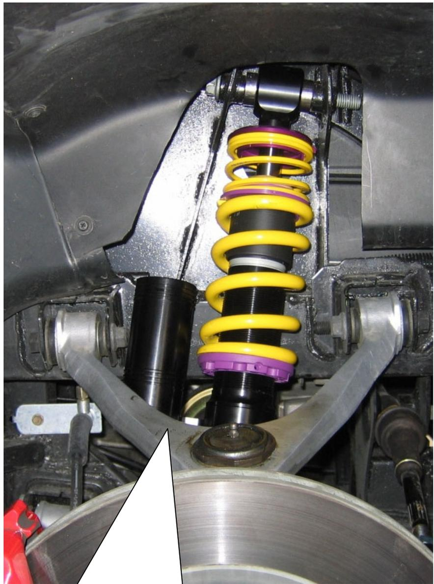
Bei Dämpferausführungen mit Druckausgleichsbehälter ist dieser, wie auf dem Bild zu sehen, zur Fahrzeugvorderseite zu montieren.
