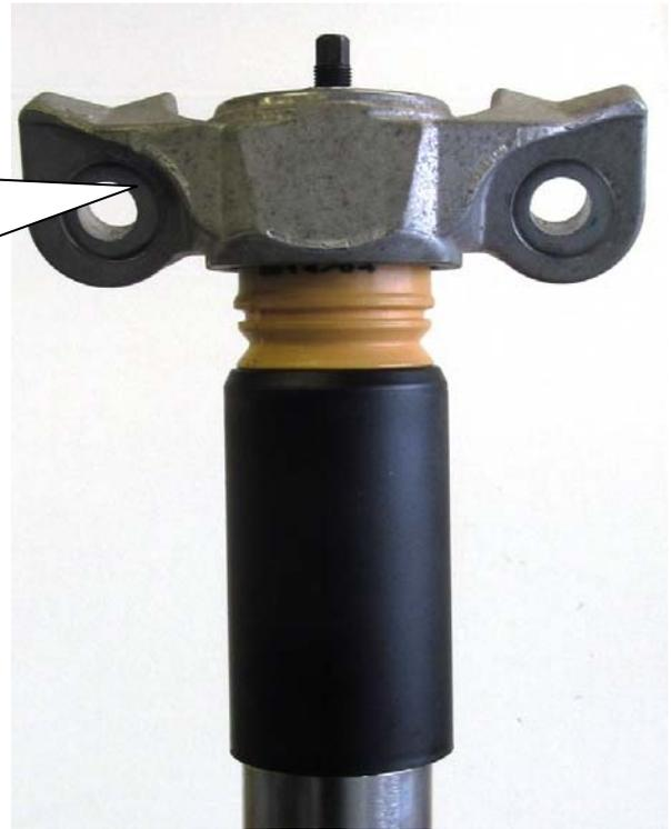
Der Anschluss für den Druckausgleichsbehälter muss zur Fahrzeugheckseite zeigen.
