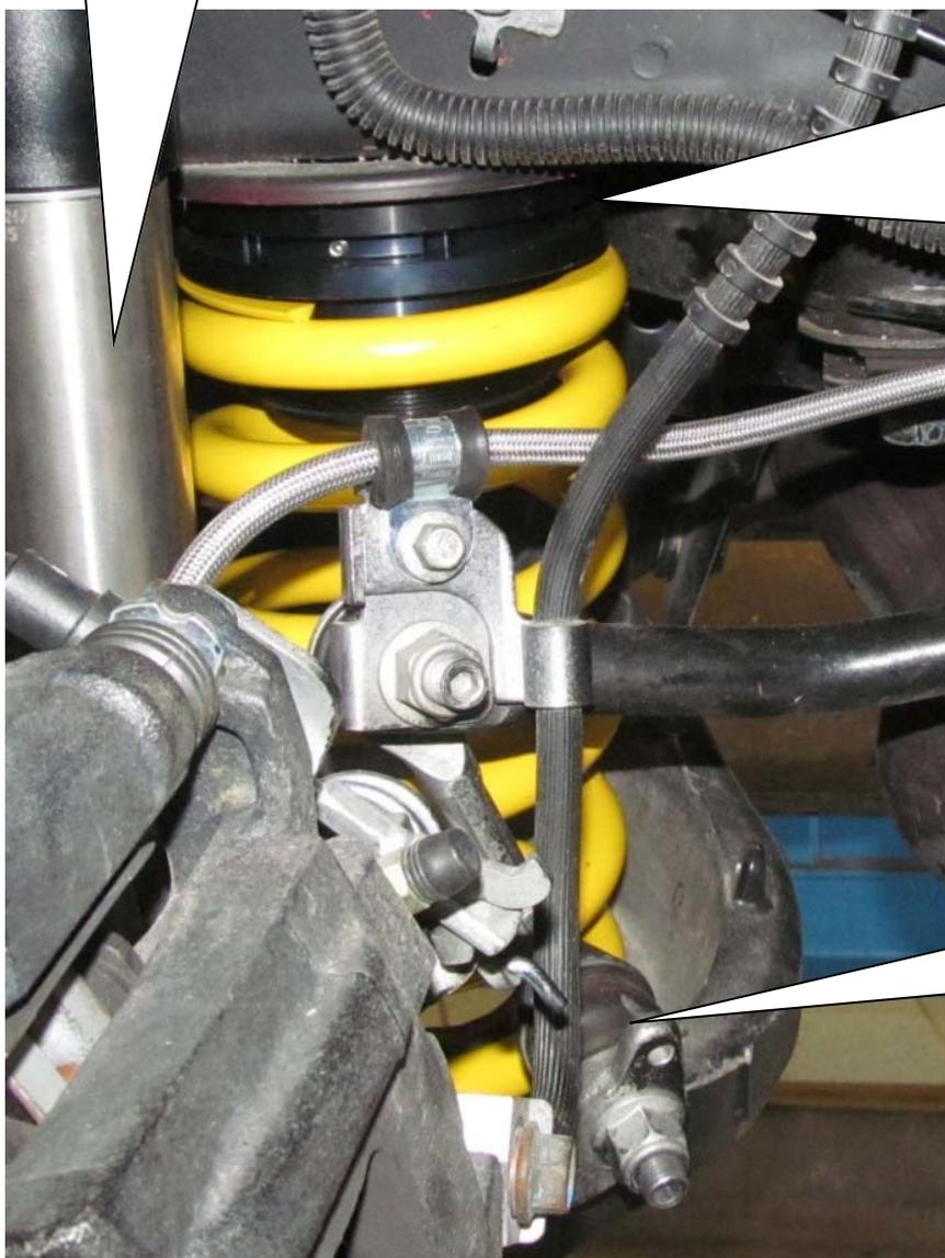
Die HA-Verstellung wird oben zwischen Feder und Karosserie montiert. Die serienmäßige Federunterlage entfällt. Zum Korrigieren (verdrehen des Gewinderings) der Fahrzeughöhe, ist die HA-Verstellung aus dem Fahrzeug zu demontieren. Achtung: Vor dem Einsetzen der Höhenverstellung müssen die Berührungsflächen gereinigt werden.
