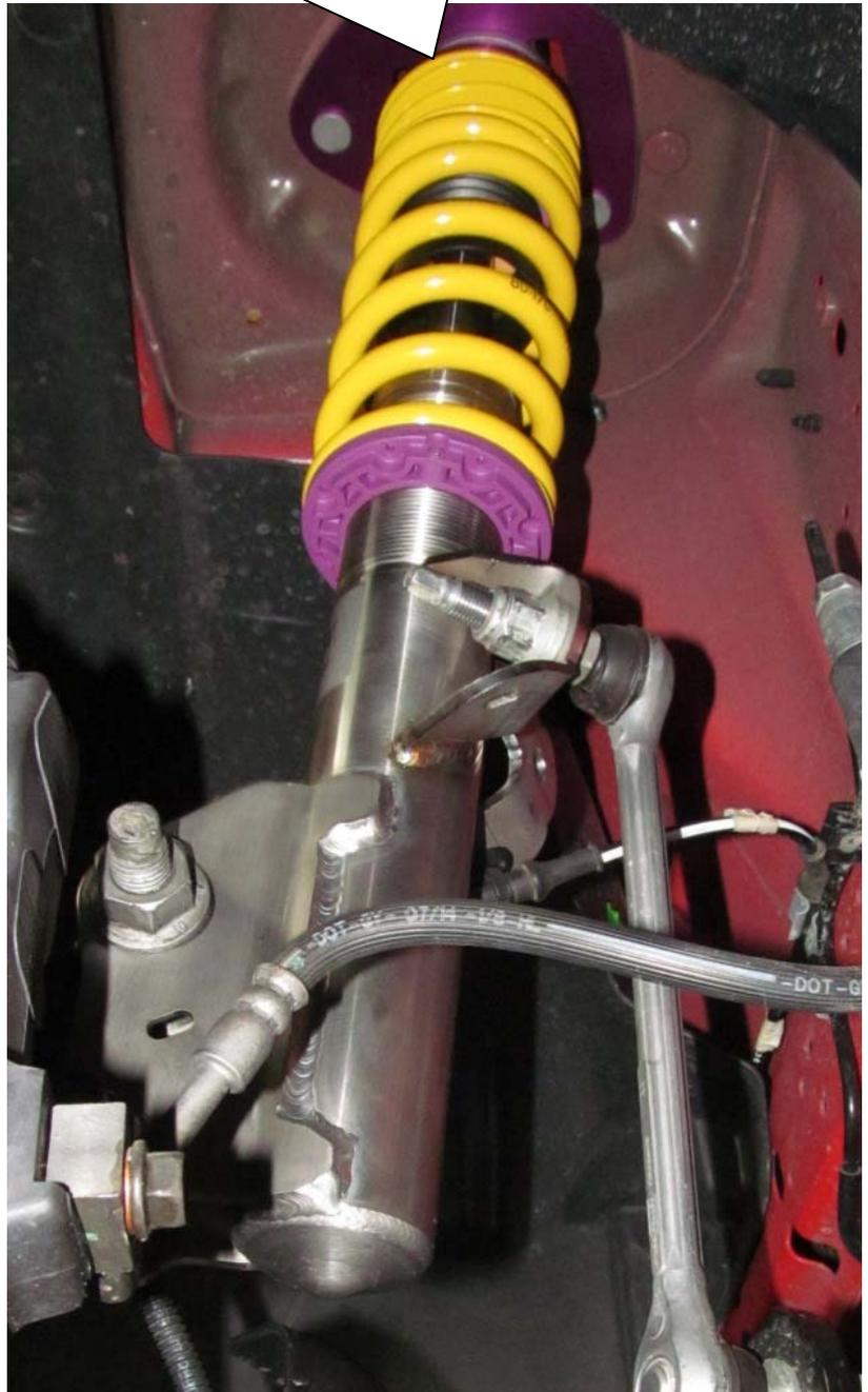
Nach erfolgreichem Einbau des Fahrwerkes ist die Freigängigkeit der Bereifung zum VA-Federbein zu überprüfen. Das Mindestabstandsmaß darf an der engsten Stelle **5 mm** nicht unterschreiten und ist gegebenenfalls mittels handelsüblicher, TÜV geprüfter Distanzscheiben wieder herzustellen.
