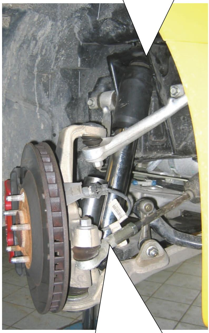
Bei Dämpferausführungen mit Druckausgleichsbehälter ist dieser, wie auf dem Bild zu sehen, zur Fahrzeugaußenseite zu montieren.
