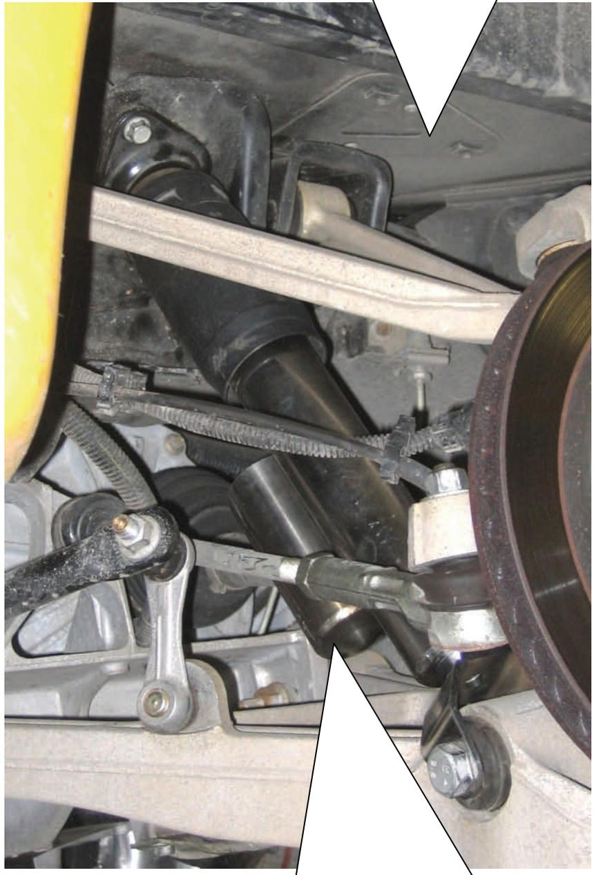
Bei Dämpferausführungen mit Druckausgleichsbehälter ist dieser, wie auf dem Bild zu sehen, zur Fahrzeuginnenseite zu montieren.
