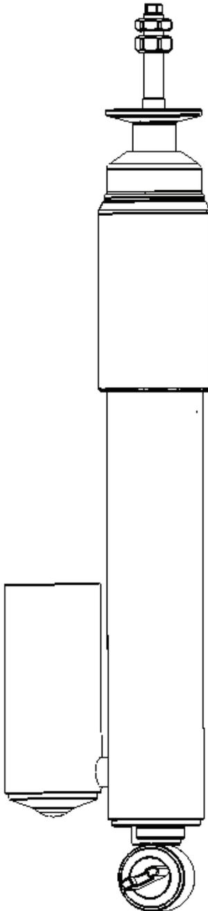
Das Anzugsdrehmoment der Kolbenstangenbefestigung beträgt 20 Nm. Die Montagehinweise zum Einbau des Dämpfers in das Fahrzeug, sowie die Anzugsdrehmomente der Dämpferbefestigung, entnehmen Sie bitte den Unterlagen des Fahrzeugherstellers.
