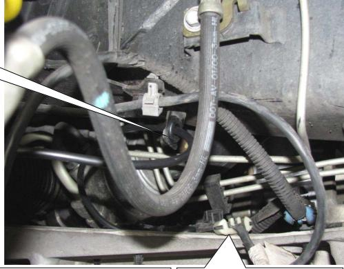
ken. Originale Dämpfersteuerungsleitung fer- Sttandard damper control wire
