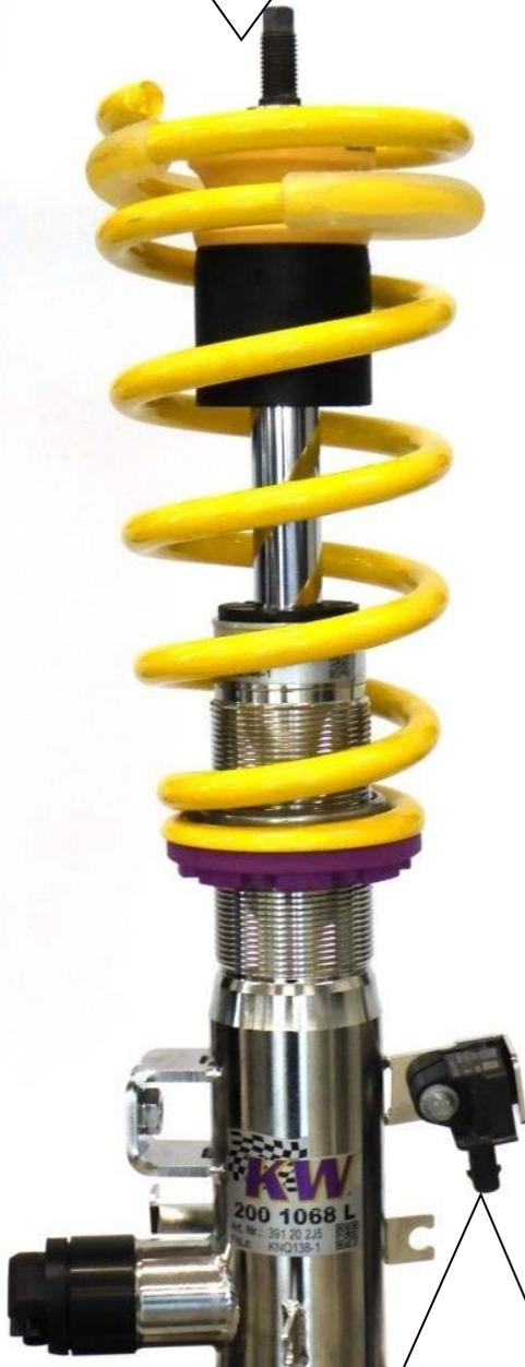
Original Beschleunigungssensor am Federbein montieren.
