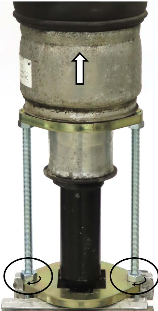
Muttern abwechselnd nach unten drehen. Dadurch wird der Luftballg vom Dämpfer nach oben gedrückt.
