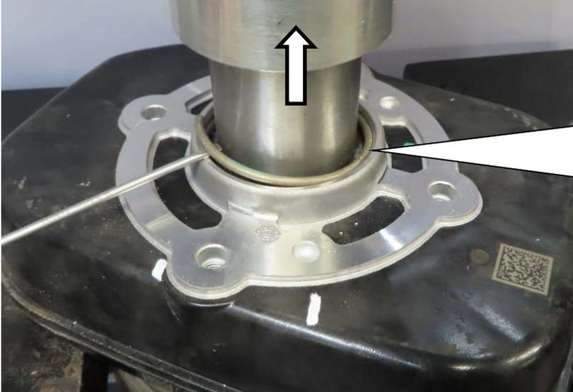
Spannring entnehmen und Presse **langsam** zurück fahren.
