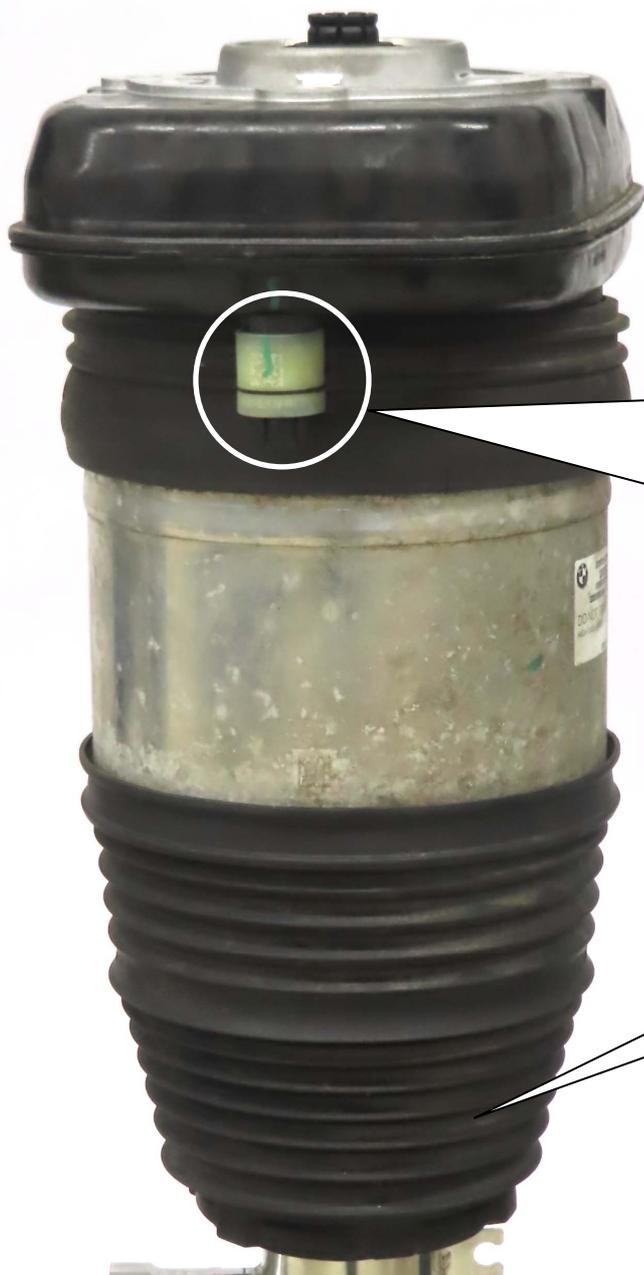
Nach der Montage des Luftbalgs muss das System manuell mit Pressluft gefüllt werden. Hierzu mit einer Pressluftpistole durch die Zuleitungsöffnung Luft einblasen.
