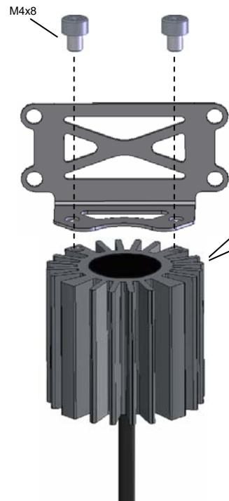
Stilllegungen an der Halterung mit den mitgelieferten M4 Schrauben montieren.
