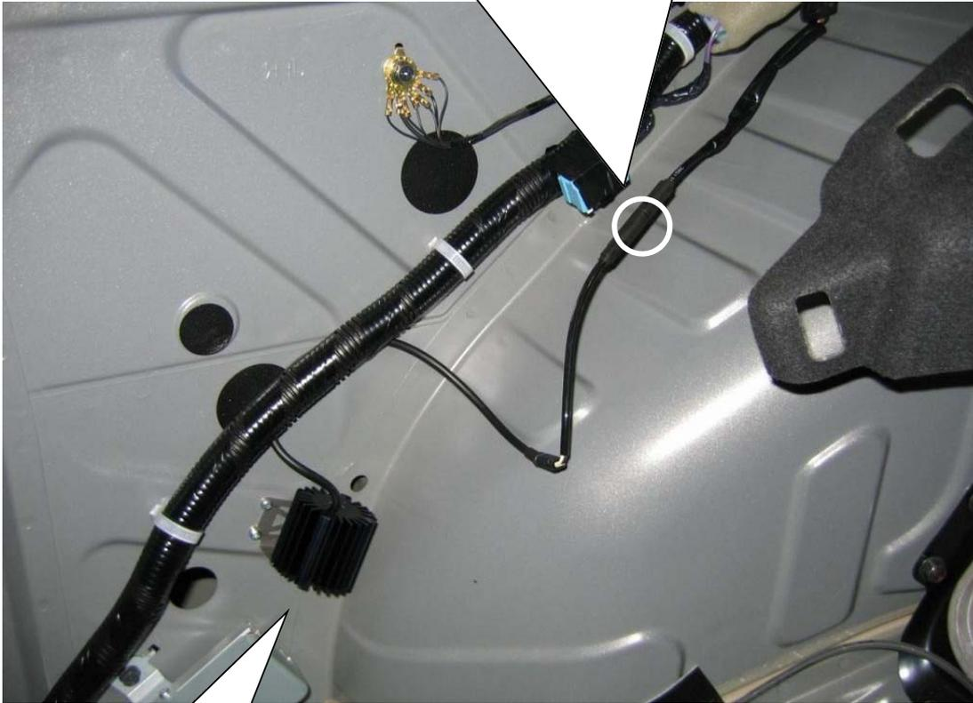
Stilllegungen und Halterung mit den mitgelieferten Blechschrauben am Fahrzeug montieren.
