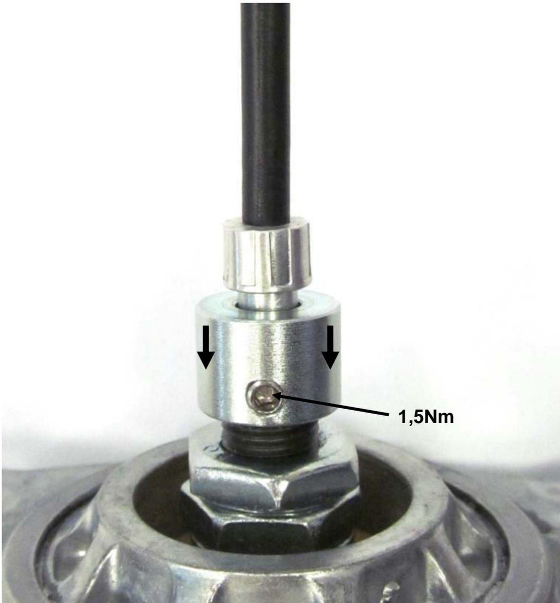
Sollte die Verlängerung durch eine kleine Öffnung geführt werden, so kann das Einstellrad demontiert werden.
