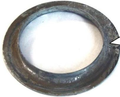
Federunterlage, welche serienmäßig in der Achse unter der Feder eingelegt ist, muss entfernt werden.
