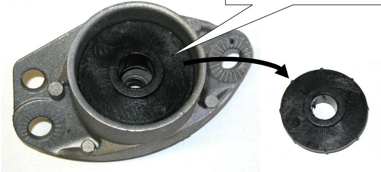
Sofern im Lieferumfang kein Anschlagpuffer enthalten ist, wird der serienmäßige Anschlagpuffer in ungekürzter Ausführung weiterverwendet. Dieser muss sich in einwandfreiem Zustand befinden und ist ggf. zu erneuern. Das Anzugsdrehmoment der Kolbenstangenbefestigung beträgt 25 Nm. Die Montagehinweise zum Einbau des Dämpfers in das Fahrzeug, sowie die Anzugsdrehmomente der Dämpferbefestigung, entnehmen Sie bitte den Unterlagen des Fahrzeugherstellers.
