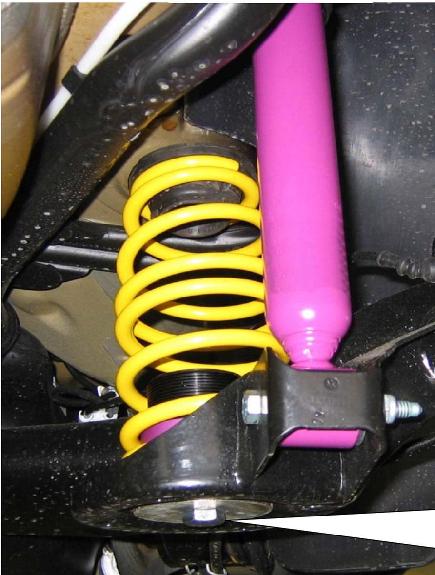
Höhenverstellung einsetzen, und mit Unterlegscheibe und Schraube verschrauben. (Anzugsmoment 25Nm). Achtung: Vor dem Einsetzen der Höhenverstellung müssen die Berührungsflächen gereinigt werden !
