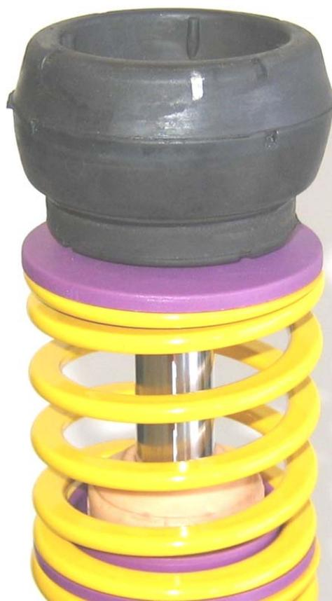
Nach erfolgtem Einbau des Fahrwerkes ist die Freigängigkeit der Bereifung zum VA-Federbein zu überprüfen. Das Mindestabstandsmaß darf an der engsten Stelle **5 mm** nicht unterschreiten und ist gegebenenfalls mittels handelsüblicher, geprüfter Distanzscheiben wieder herzustellen.
