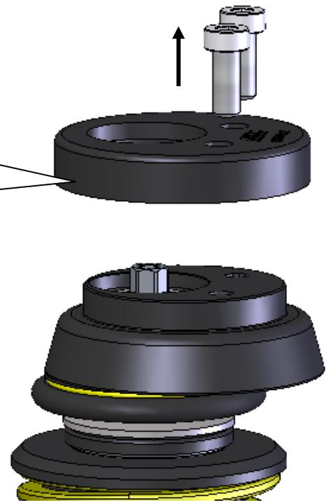
Die Auflagefläche des Stützlagers an der Karosserie muss zuvor gründlich gereinigt werden!
