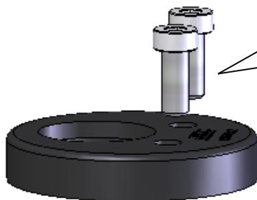
Halteplatte auf dem Domlager mit den beiden Schrauben montieren. Durch drehen der Halteplatte ändert sich der Fahrzeugsturz sowie die Nachlauf. Das Anzugsdrehmoment der beiden Schrauben beträgt 22Nm.
