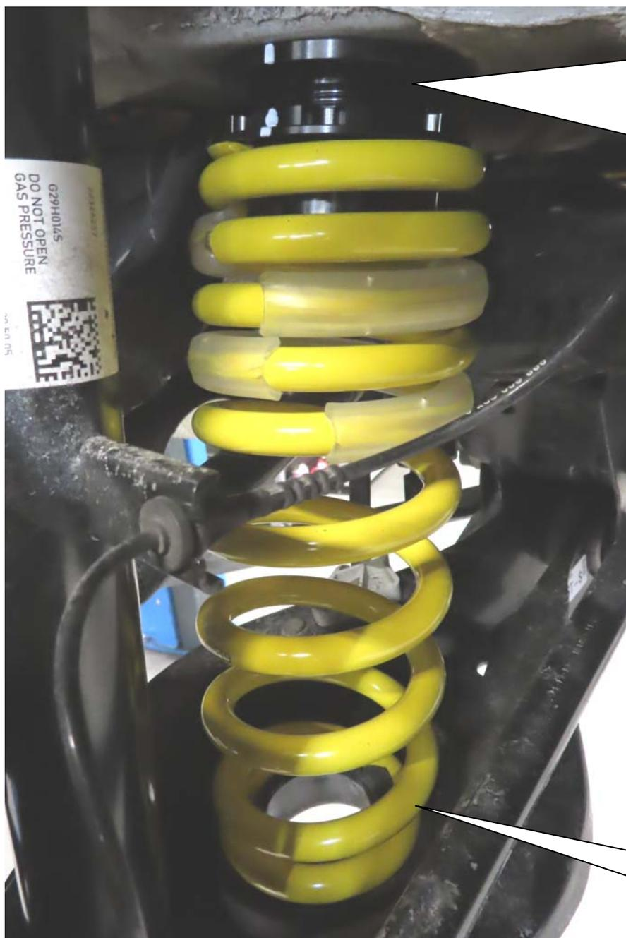
Die HA-Verstellung wird oben zwischen Feder und Karosserie montiert. Die serienmäßige Federunterlage entfällt. Zum Korrigieren (verdrehen des Gewinderings) der Fahrzeughöhe, ist die HA-Verstellung aus dem Fahrzeug zu demontieren.
