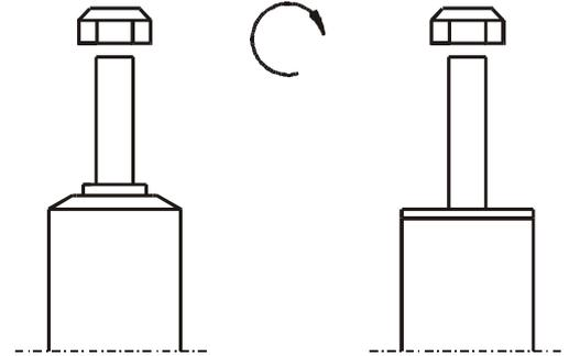
ZUM LÖSEN UND ANZIEHEN DER MUTTERN DARF KEIN SCHLAGSCHRAUBENDREHER VERWENDET WERDEN DAS BEFESTIGUNGSGEWINDE WIRD SONST ZERSTÖRT. SELBSTSICHERNDE MUTTERN DÜRFEN NUR **EINMAL VERWENDET** WERDEN!
