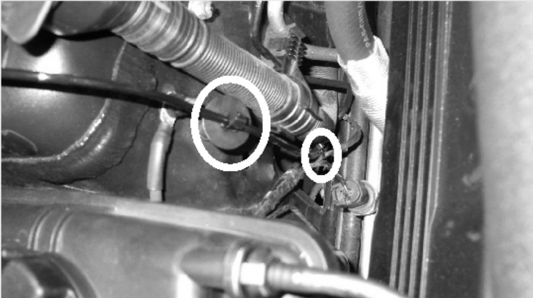
Die Kunststoff- Abdeckung des Original Federbeins wieder auf den Dom clipsen. Das neue Steckergehäuse des Adapterkabels auf den gegenüber liegenden freien Steckplatz schieben. Das original Steckergehäuse verbleibt am ursprünglichen Platz im Fahrzeug.
