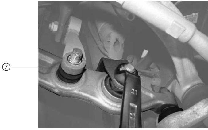
■ Federbeingabel am unteren Querlenker montieren ⑦.
