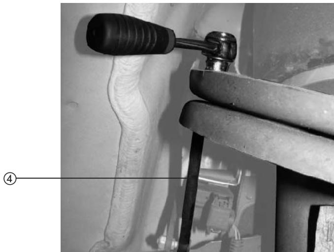
■ Höhenstandssensorgestänge montieren ④.
