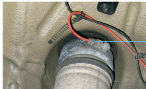
**اسند الصمام المحافظ على الضغط المتبقي أثناء حل برغي الفتحة. لا تثني الماسورة أو تلفها أو تضغطها! افتح ضغط الهواء بشكل بطيء ودع الهواء يتسرب.**
