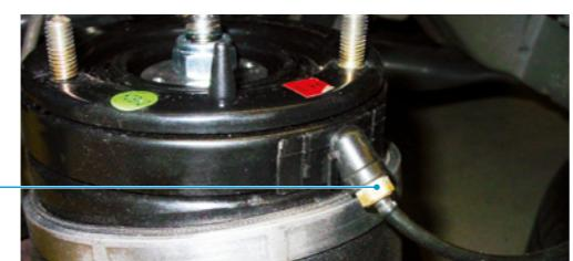
Следует избегать перегиба, перекручивания или пережима напорной магистрали.
