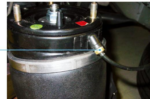
! 不要弯曲、扭曲或挤压压缩空气导管。
