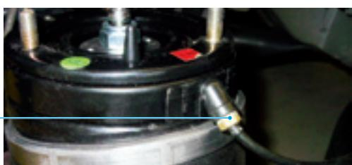
**Следует избегать перегиба, перекручивания или пережима напорной магистрали.**
