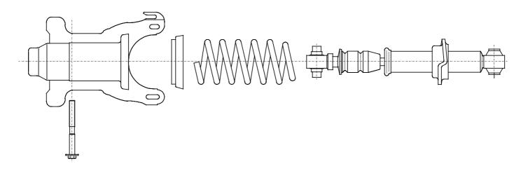
Bei der Montage des Federtellers (1) ist auf den korrekten Sitz des Sprengringes (2) zu achten!
