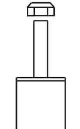
ZUM LÖSEN UND ANZIEHEN DER MUTTERN DARF KEIN SCHLAGSCHRAUBENDREHER VERWENDET WERDEN DAS BEFESTIGUNGSGEWINDE WIRD SONST ZERSTÖRT. SELBSTSICHERNDE MUTTERN DÜRFEN NUR **EINMAL VERWENDET** WERDEN!
