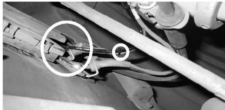
Auf der Beifahrerseite das Kabel parallel zum Einfüllstutzen der Wischwaschanlage verlegen und mit einem Kabelbinder (BILSTEIN Lieferumfang) auf dem Gewindestift unter dem Masseanschluss sichern.
