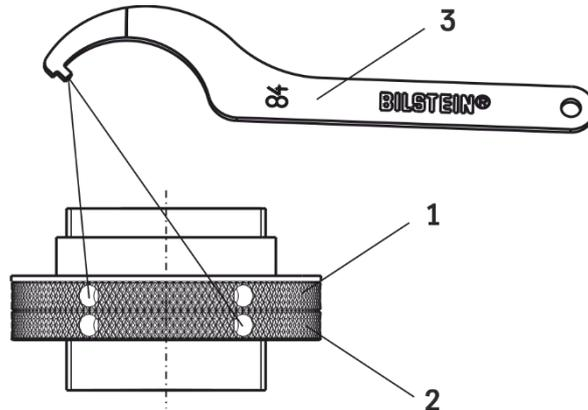
Die Sicherung von Federteller (1) und Kontermutter (2) erfolgt mit Hilfe des im BILSTEIN Lieferumfang enthaltenen Hakenschlüssel (3).
