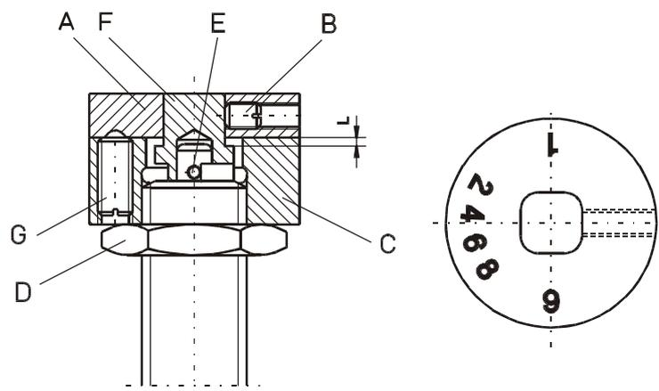
Verstellposition **9** = **weich** ( im Uhrzeigersinn drehen )
