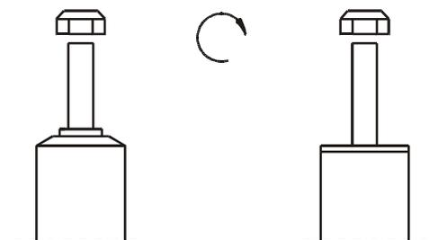
**Um eine mögliche Zerstörung des Produktes zu vermeiden, darf zum Lösen und Anziehen der Muttern kein Schlagschraubendreher verwendet werden.**
