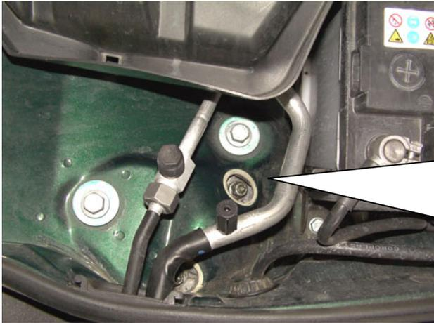
Beachten Sie beim Ausbau des VA Federbeins, dass das Federbein durch Entfernen der Verschlussstopfen im Motorraum und das Entfernen der dann sichtbaren Befestigungsschrauben an der Achse gelöst wird. (Der Verschlussstopfen muss ggf. erneuert werden VAG Bestell Nr.: N 102 265 01) Zerlegen Sie keinesfalls die obere Querlenkerkonstruktion, da sonst erhebliche Vermessungsarbeiten der VA notwendig werden.
