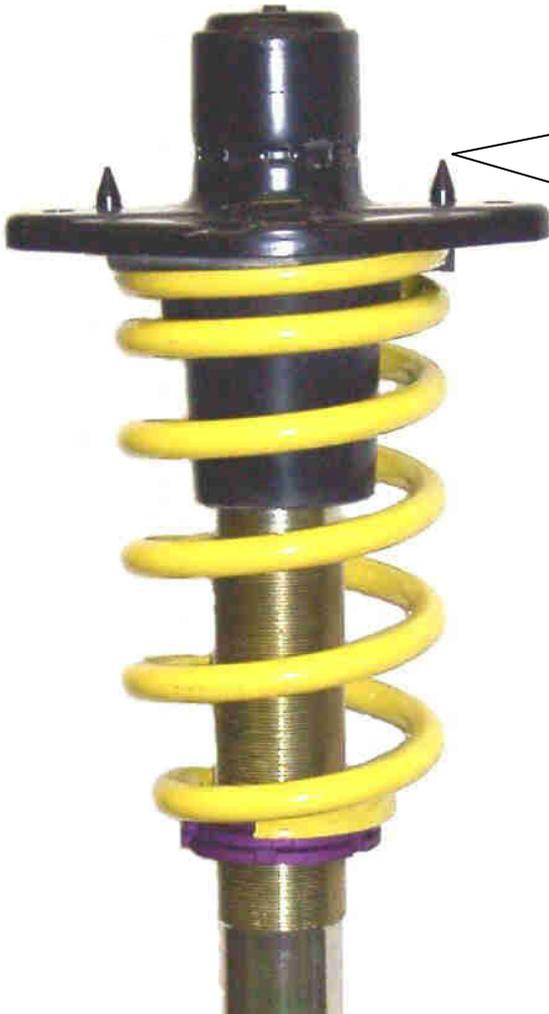
Komplett montiertes HA-Federbein. Das Anzugsdrehmoment der Kolbenstangenbefestigung beträgt 25 Nm. Die Montagehinweise zum Einbau des Federbeines in das Fahrzeug, sowie die Anzugsdrehmomente der Federbeinbefestigung, entnehmen Sie bitte den Unterlagen des Fahrzeugherstellers.
