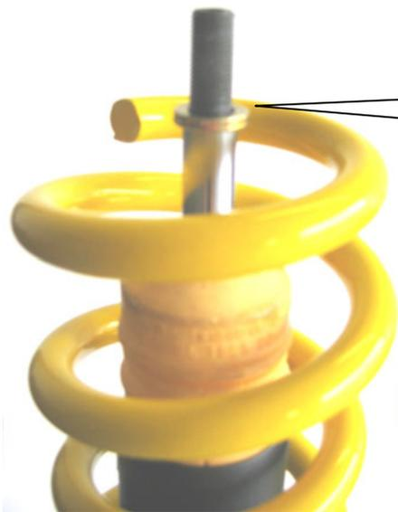
Angeliefertes Federbein mit aufgesteckter Serienstützscheibe. Bei Var.1 und 2 muss diese wie im Bild montiert werden, bei Var. 3 wird diese nicht montiert.
