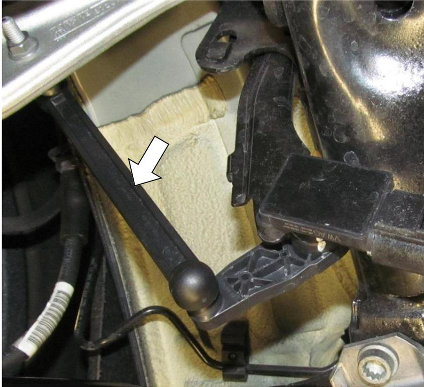
Koppelstange aus dem Querlenker und dem Sensor demontieren.
