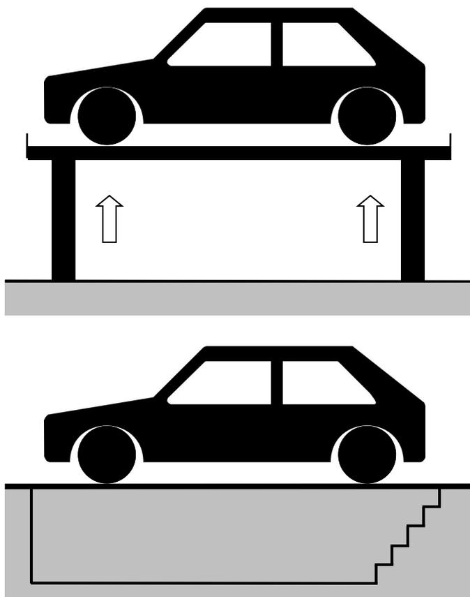
Fahrzeug nach dem Umbau auf einer 4-Säulenhebebühne anheben. Alternativ kann das Fahrzeug auch auf eine Grube gefahren werden.
