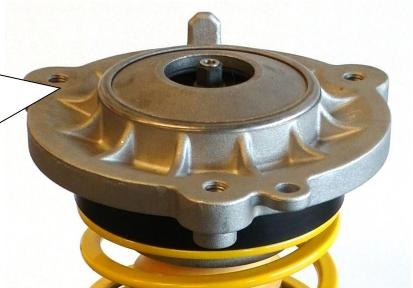
Original Abdeckung wieder am Stützlager montieren.
