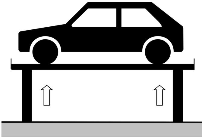
Fahrzeug im Originalzustand auf einer 4-Säulenhebebühne anheben. Alternativ kann das Fahrzeug auch auf eine Grube gefahren werden.
