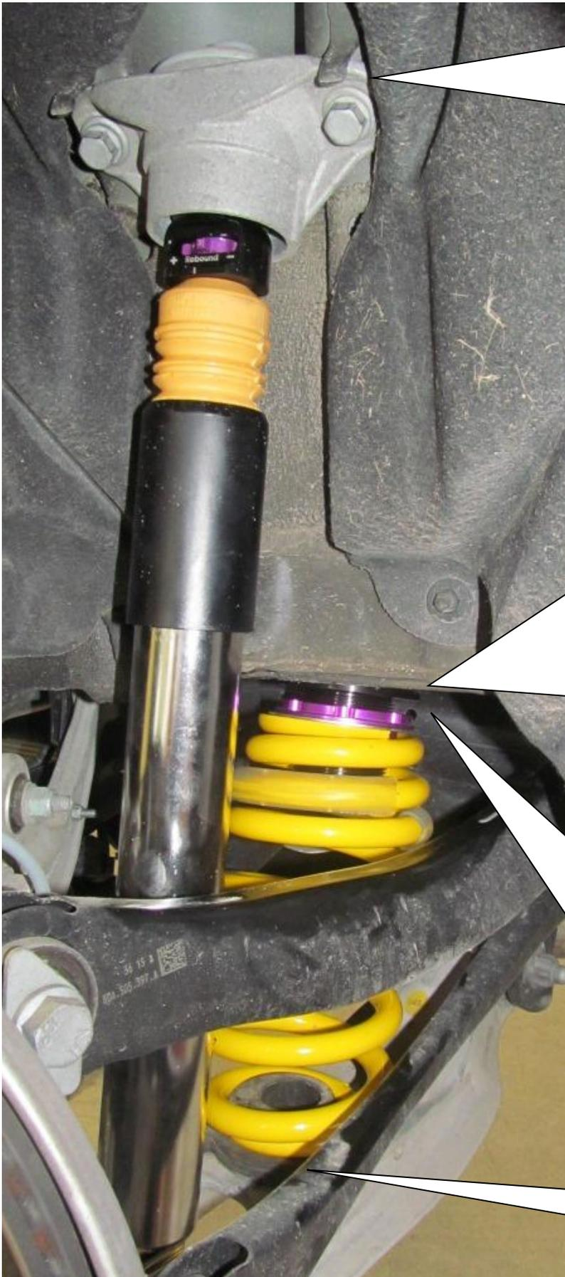
Original Stützlager aufstecken und mit der mitgelieferten Stopmmutter verschrauben. Das Anzugsdrehmoment der Kolbenstangenbefestigung beträgt 20 Nm. Die Montagehinweise zum Einbau des Dämpfers in das Fahrzeug, sowie die Anzugsdrehmomente der Dämpferbefestigung, entnehmen Sie bitte den Unterlagen des Fahrzeugherstellers.
