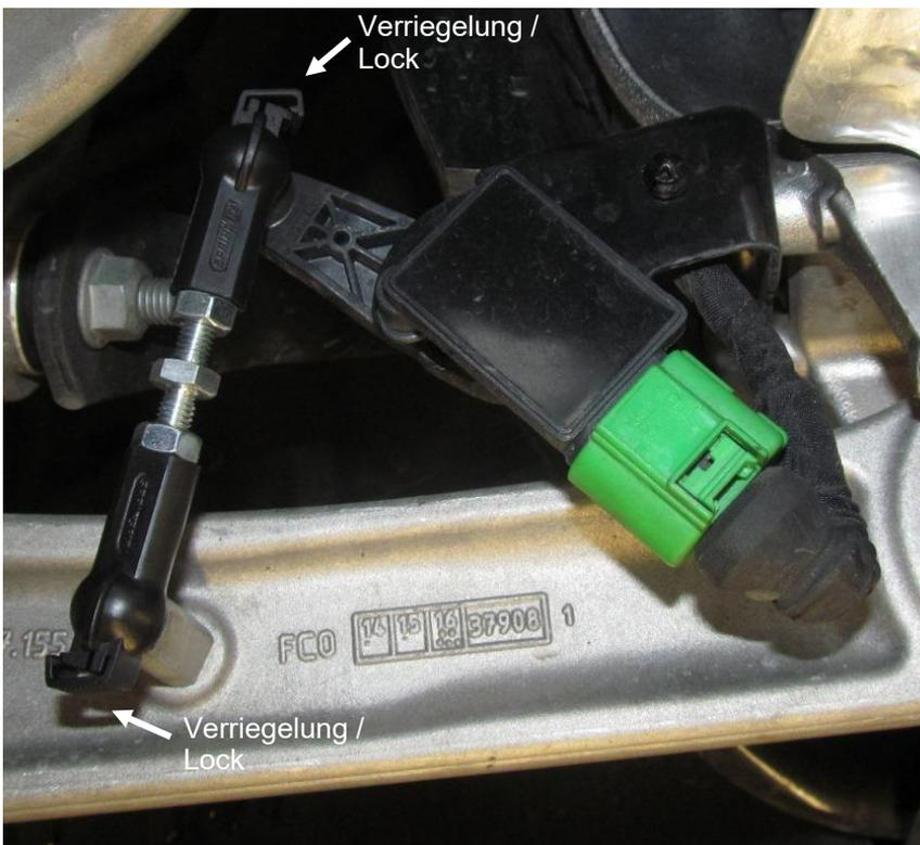
Mitgelieferte einstellbare Koppelstange montieren und verriegeln.
