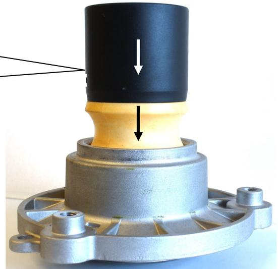
Aufgesteckte Hülse von oben in das Stützlager einlegen / einpressen.
