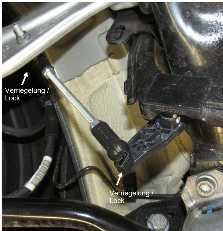
Mitgelieferte einstellbare Koppelstange montieren und verriegeln.
