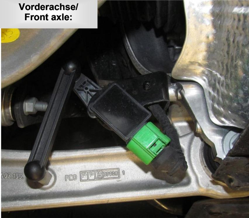
Hebelarmposition der VA Höhensensoren mit einem Stift (rechts und links) markieren.
