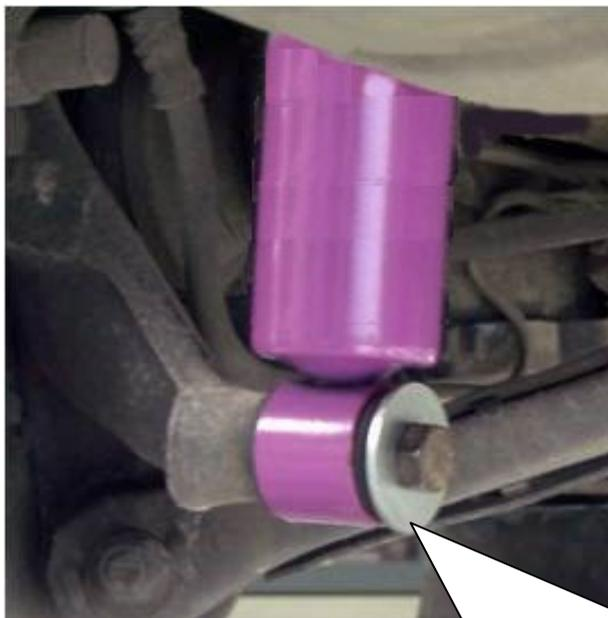
Bei der unteren Dämpferbefestigung muss die mitgelieferte Beilagscheibe eingebaut werden. Dabei darauf achten, dass die Scheibe in Richtung Fahrzeugmitte montiert wird (siehe Bild).
