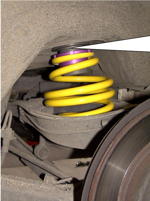
Die Höhenverstellung wird oben eingesetzt. Die serienmäßige, obere Federunterlage wird nicht mehr verwendet. Die serienmäßige, untere Federunterlage wird weiterverwendet. Zum Korrigieren der Fahrzeughöhe entnehmen Sie bitte die Höhenverstellung.
