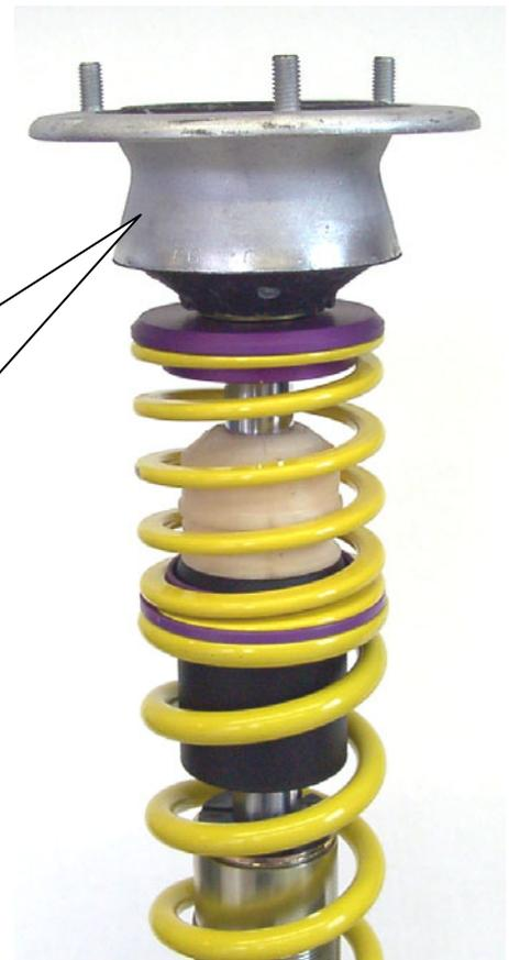
Das Original Stützlager aufsetzen und mit der mitgelieferten Stopmmutter verschrauben. Das Anzugsdrehmoment der Kolbenstangenbefestigung beträgt 50 Nm. Die Montagehinweise zum Einbau des Federbeines in das Fahrzeug, sowie die Anzugsdrehmomente der Federbeinbefestigung, entnehmen Sie bitte den Unterlagen des Fahrzeugherstellers.
