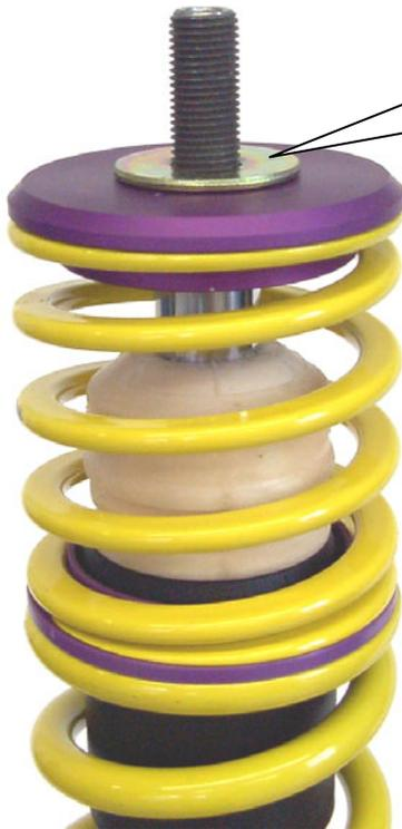
Serienmäßige Beilagscheibe muss zwischen Federteller und Stützlager montiert werden
