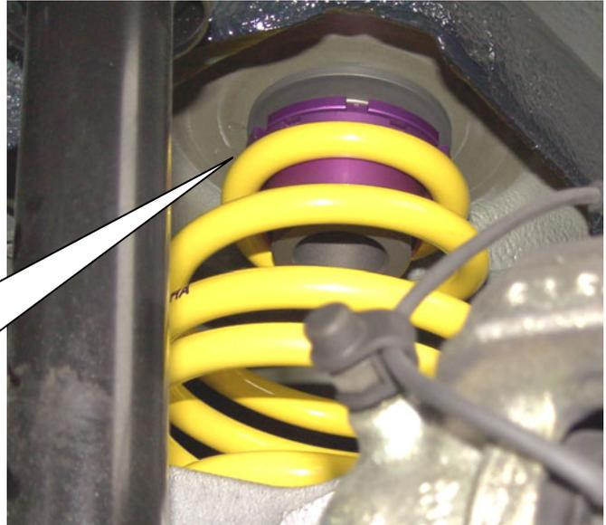
Die Höhenverstellung (Gewindehülse und Nutenring) ist oben an der Feder einzusetzen. Zum Korrigieren der Fahrzeughöhe ist der Stoßdämpfer an der Achse zu lösen und die Verstellung zu entlasten bzw. zu demontieren
