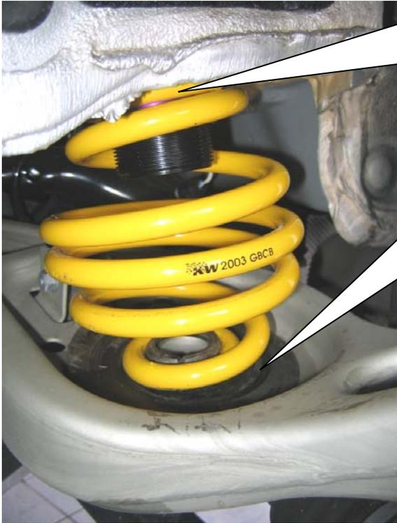
Mittelgelieferte Höhenverstellung wird ohne Gummiunterlage zwischen Karosserie und Feder montiert. Die obere Gummiunterlage wird später unten weiterverwendet. Zum korrigieren (verdrehen des Gewinderings) der Fahrzeughöhe ist die Verstellung aus dem Fahrzeug zu demontieren.
