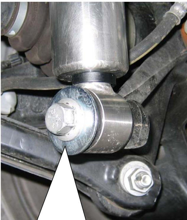
Bei der unteren Dämpferbefestigung muss die mitgelieferte Beilagscheibe eingebaut werden. Dabei darauf achten, dass die Scheibe in Richtung Fahrzeugmitte montiert wird (siehe Bild).
