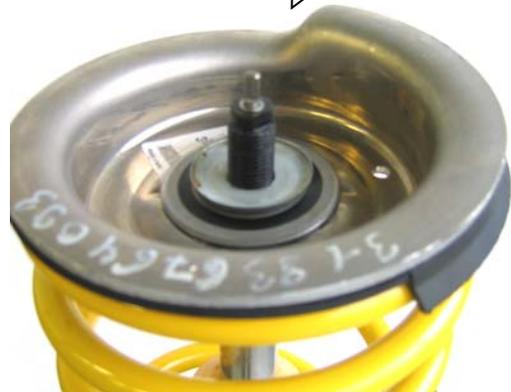
Original Stützlagereinheit aufsetzen und mit der mitgelieferten Mutter verschrauben. Das Anzugsdrehmoment der Kolbenstangenbefestigung beträgt 50 Nm. Die Montagehinweise zum Einbau des Federbeines in das Fahrzeug, sowie die Anzugsdrehmomente der Federbeinbefestigung, entnehmen Sie bitte den Unterlagen des Fahrzeugherstellers.
