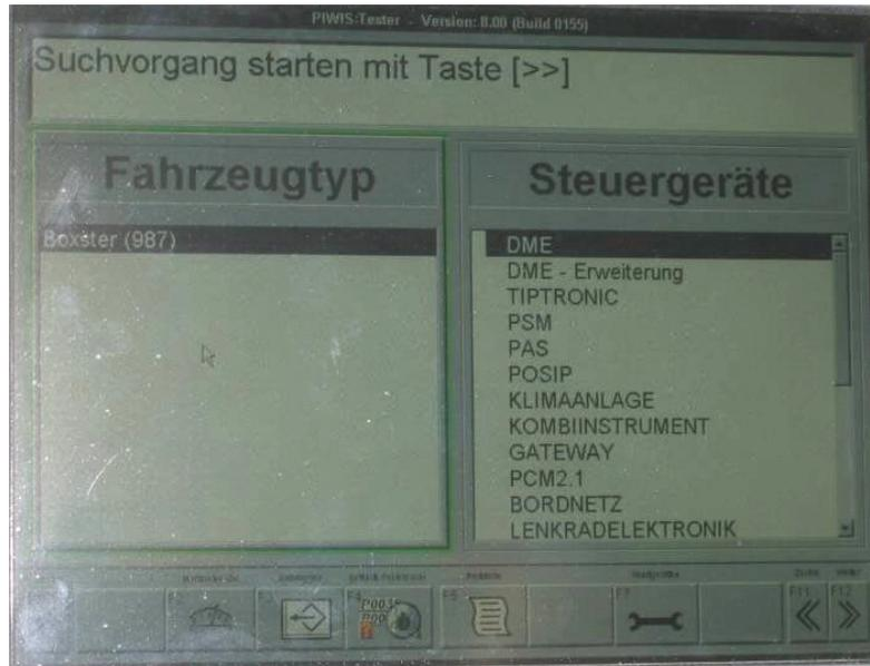
3.) Fehlerspeicher überprüfen und gegebenenfalls die Fehler löschen.
