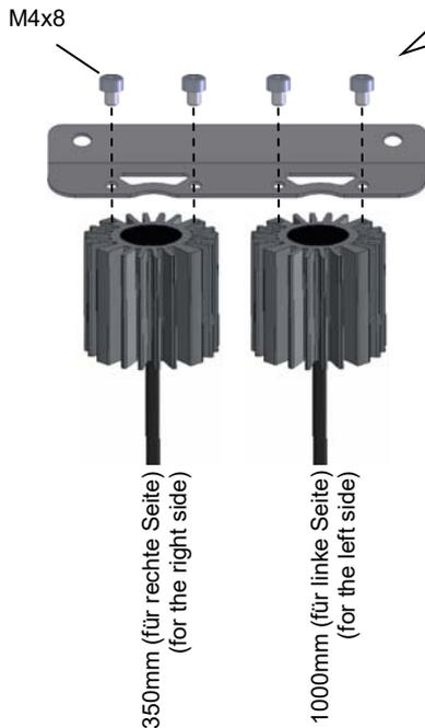
Stilllegungen und Halterung mit den mitgelieferten Schrauben und einer Stoppmutter am Fahrzeug montieren. Montageort ist neben der Batterie.
