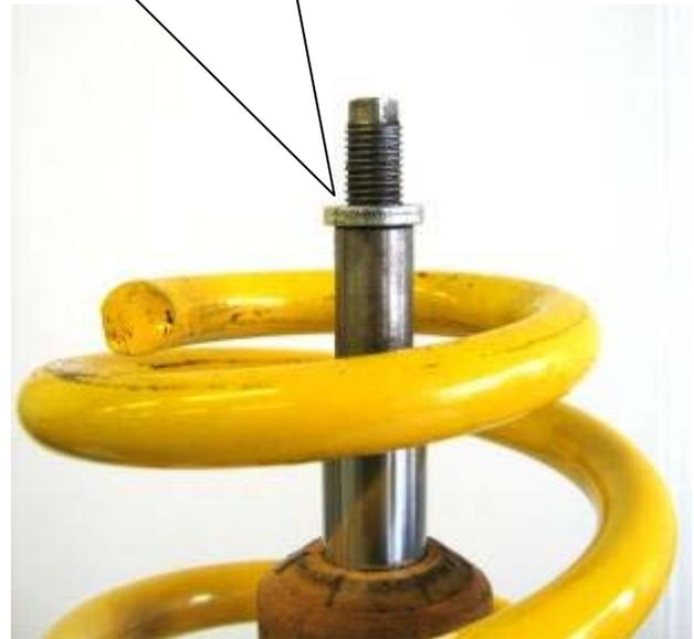
Original Stützlager aufstecken und mit der mitgelieferten Stopmutter verschrauben. Das Anzugsdrehmoment der Kolbenstangenbefestigung beträgt 35 Nm. Die Montagehinweise zum Einbau des Federbeines in das Fahrzeug, sowie die Anzugsdrehmomente der Federbeinbefestigung, entnehmen Sie bitte den Unterlagen des Fahrzeugherstellers.
