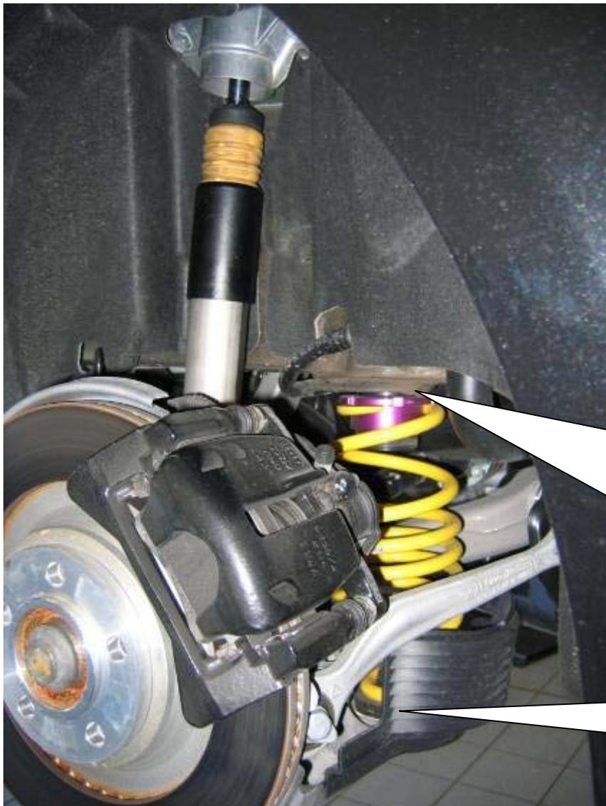
Die HA-Verstellung wird oben zwischen Feder und Karosserie montiert. Die serienmäßige Federunterlage entfällt. Zum Korrigieren (verdrehen des Gewinderings) der Fahrzeughöhe, ist die HA-Verstellung aus dem Fahrzeug zu demonstrieren.
