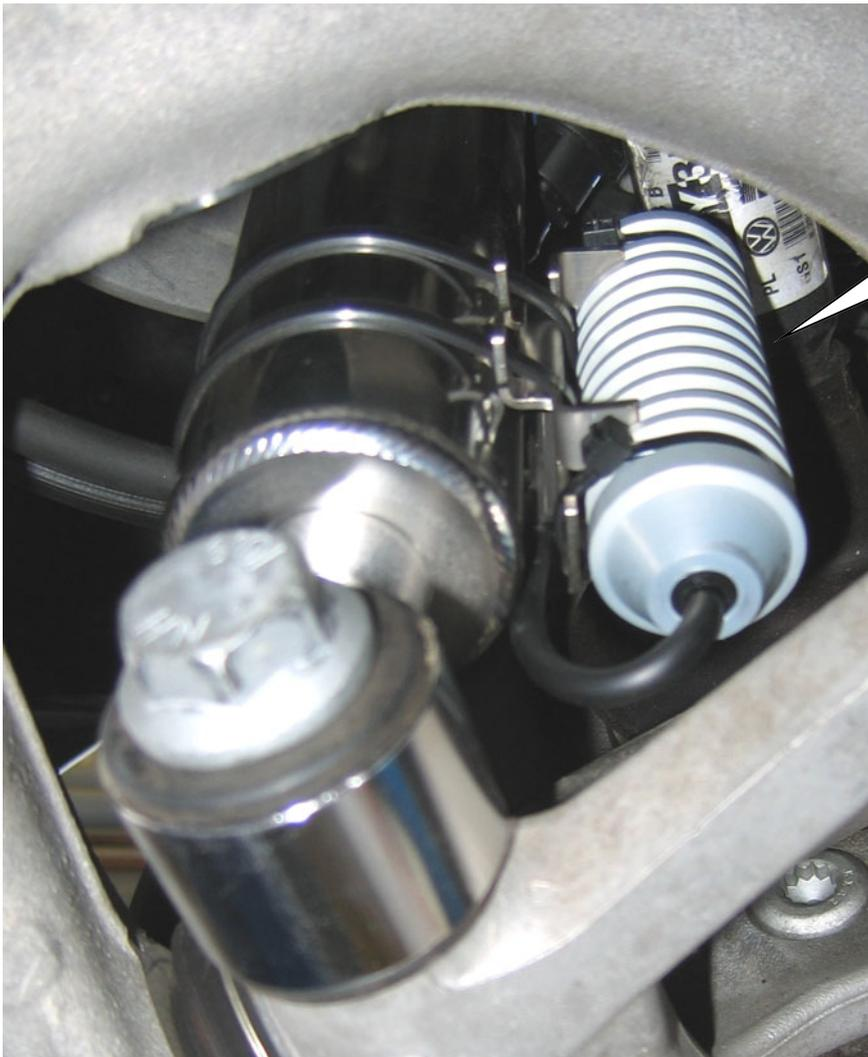
Elektronikbauteil mit Halterung am Dämpfer mittels Kabelbinder befestigen.
