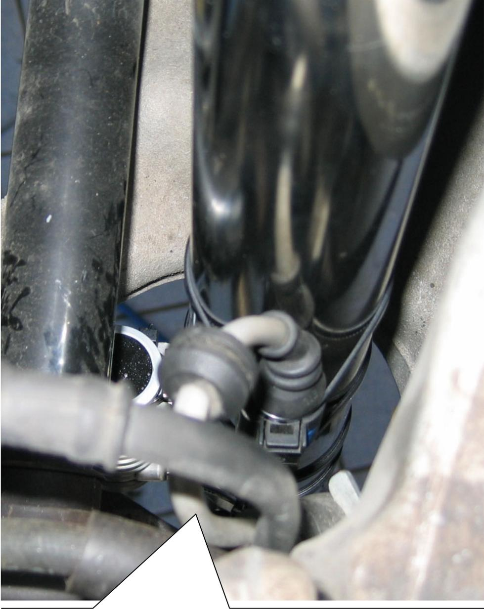
Originale Dämpfersteuerungsleitung zurück verlegen und in das mitgelieferte Elektronikbauteil einstecken. Auf die korrekte Verriegelung des Steckers achten! Anschließend originale Dämpfersteuerungsleitung mit Kabelbinder am Kabelbaum befestigen. Darauf achten dass die Leitung nirgends anliegt.
