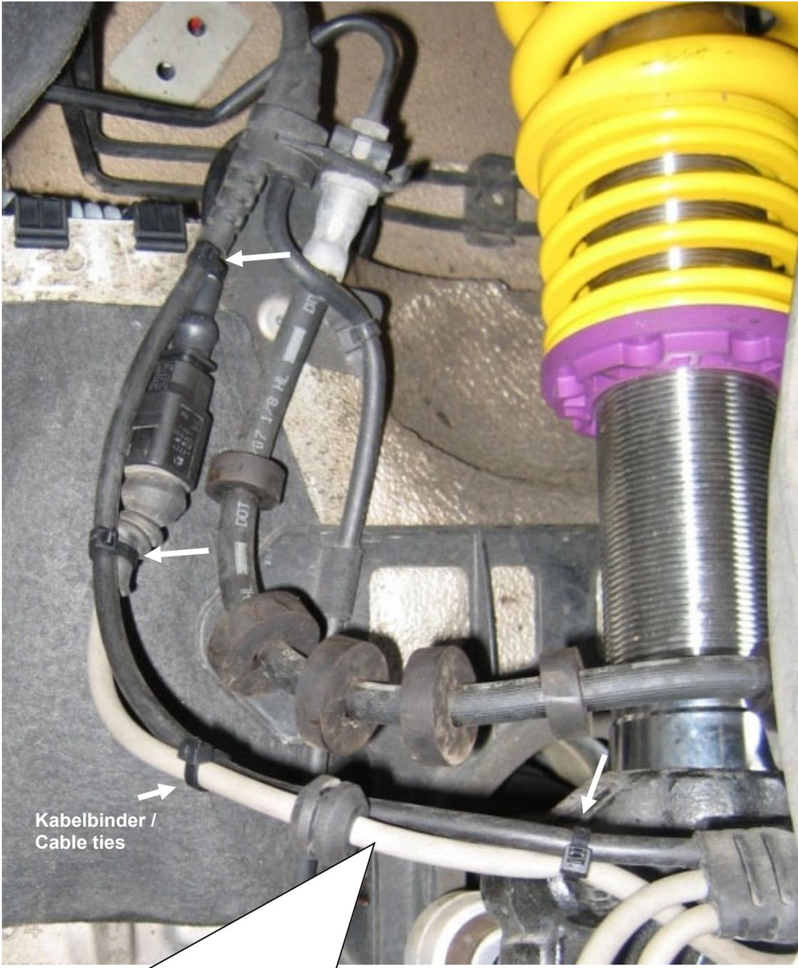
Originale Dämpfersteuerungsleitung zurück verlegen und in das mitgelieferte Elektronikbauteil einstecken. Auf die korrekte Verriegelung des Steckers achten! Anschließend originale Dämpfersteuerungsleitung mit Kabelbinder am Kabelbaum befestigen. Darauf achten dass die Leitung nirgends anliegt.
