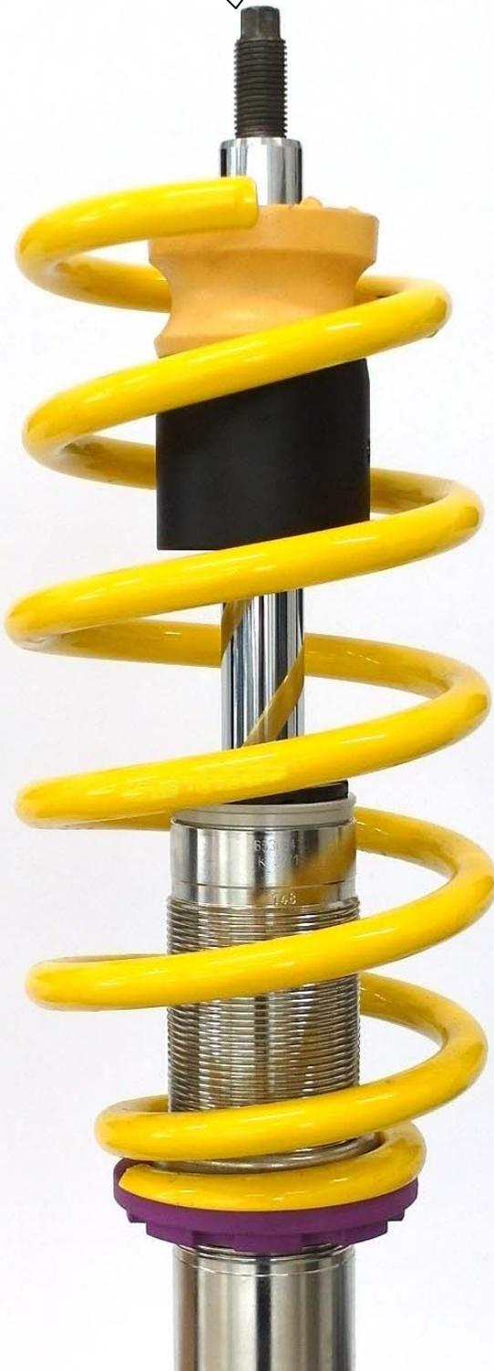
Staubschutzrohr vom originalen Stützlager trennen. Das Staubschutzrohr wird nicht länger benötigt.
