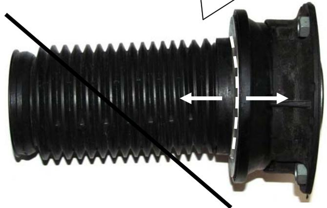
Beide Markierungen des originalen Stützlagere (Oberteil) und originalen Axiallagers (Unterteil) müssen übereinander liegen! Die Markierungen zeigen im Eingebauten Zustand zur Fahrzeuginnen-seite.
