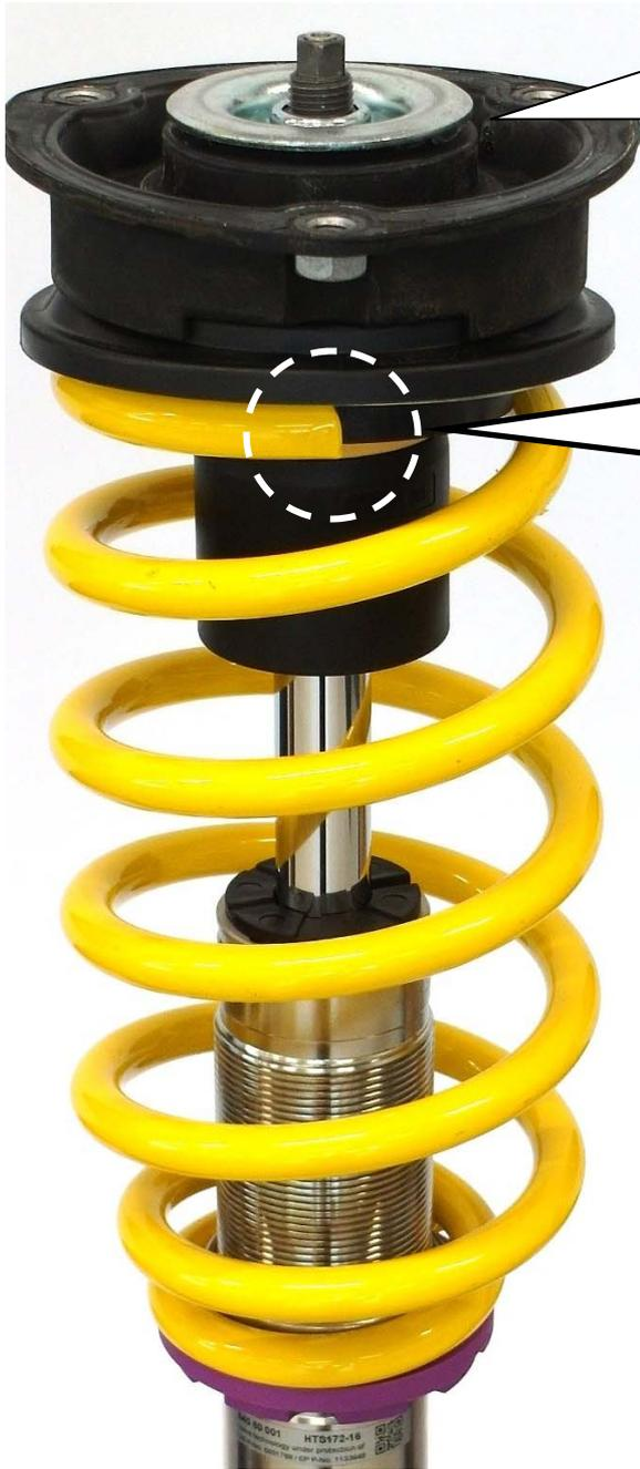
Das originale Stützlager aufsetzen und mit der im Lieferumfang enthaltenen Mutter festschrauben. Das Anzugsdrehmoment der Kolbenstangenbefestigung beträgt 50 Nm. Die Montagehinweise zum Einbau des Federbeines in das Fahrzeug, sowie die Anzugsdrehmomente der Federbeinbefestigung, entnehmen Sie bitte den Unterlagen des Fahrzeugherstellers.
