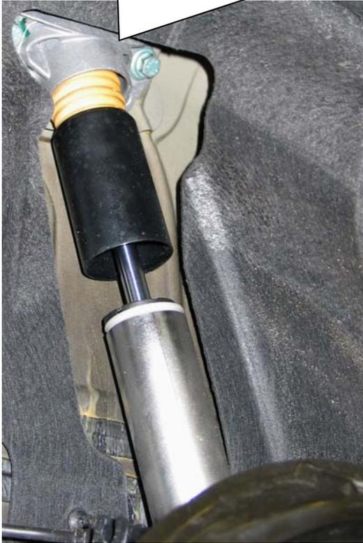
Die HA-Verstellung wird oben zwischen Feder und Karosserie montiert. Die serienmäßige Federunterlage entfällt. Zum Korrigieren (verdrehen des Gewinnderings) der Fahrzeughöhe, ist die HA-Verstellung aus dem Fahrzeug zu demontieren.
