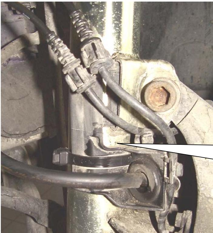
Nach erfolgtem Einbau des VA Federbeins ist die serienmäßige Kabel – und Leitungsbefestigungseinheit mittels dem mitgelieferten Kabelband zusätzlich zu befestigen.
