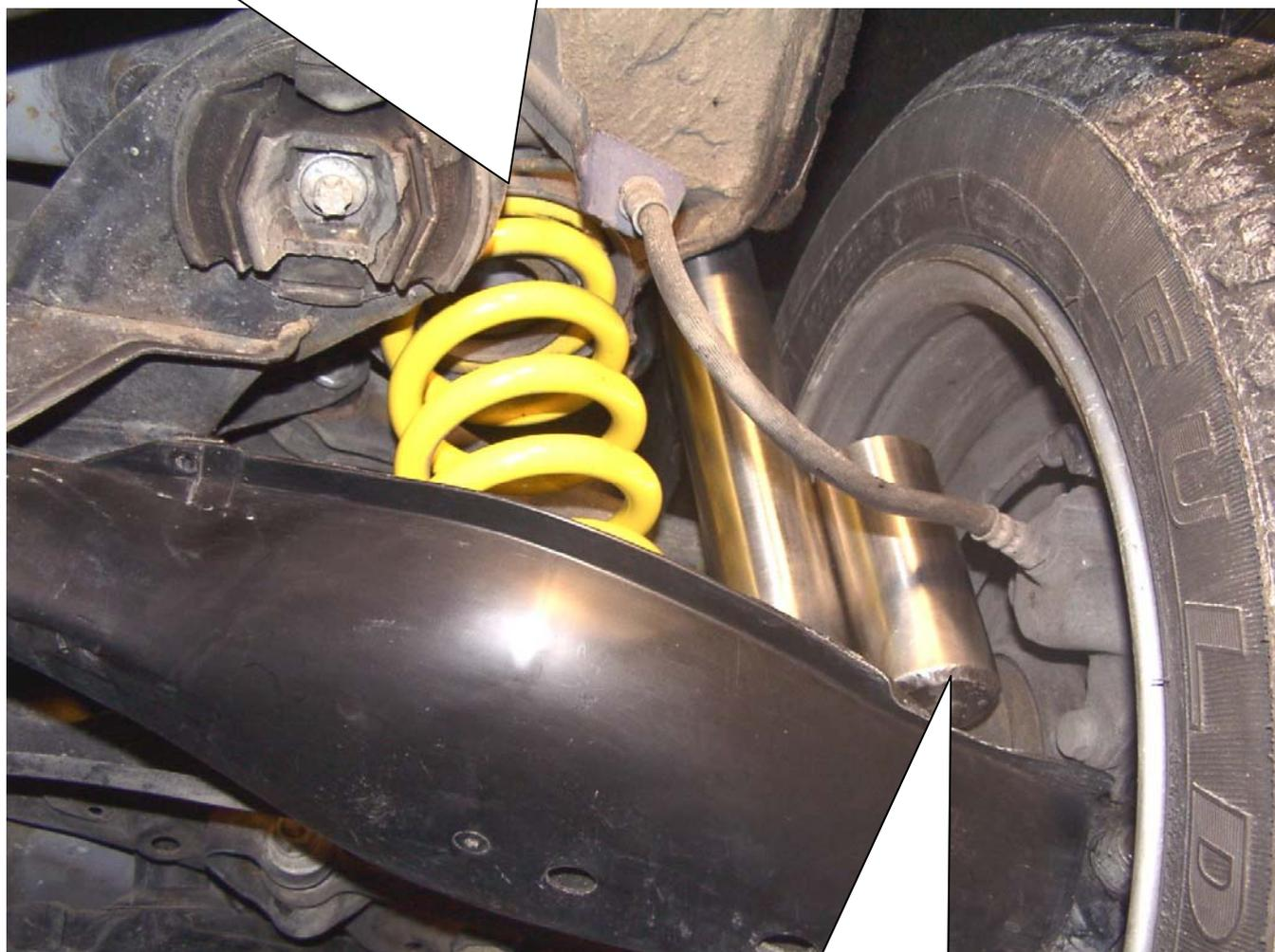
Der HA Stoßdämpfer wird montiert, wie es in den Unterlagen des Fahrzeugherstellers beschrieben wird. Sofern im Lieferumfang kein KW Anschlagpuffer enthalten ist wird der serienmäßige in ungekürzter Ausführung weiterverwendet. Dieser muss sich im einwandfreien Zustand befinden und ist ggf. zu erneuern.
