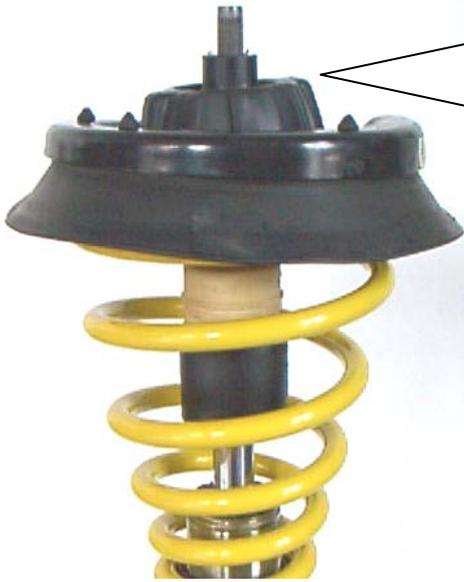
Original – Federteller und Stützlager auf die KW Feder aufsetzen und mit der serienmäßigen Schlitzmutter mittels geeignetem Werkzeug verschrauben. Dabei auf die richtige Positionierung der Feder im Federteller achten. Zur Befestigung des Federbeins im Fahrzeug verwenden Sie die mitgelieferte Stoppmutter. Anzugsdrehmoment beträgt 50 Nm.
