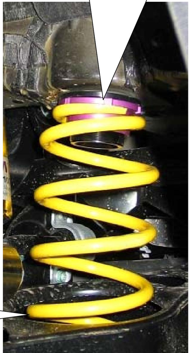
Am unteren Ende der Feder wird die originale Federunterlage weiterverwendet.
