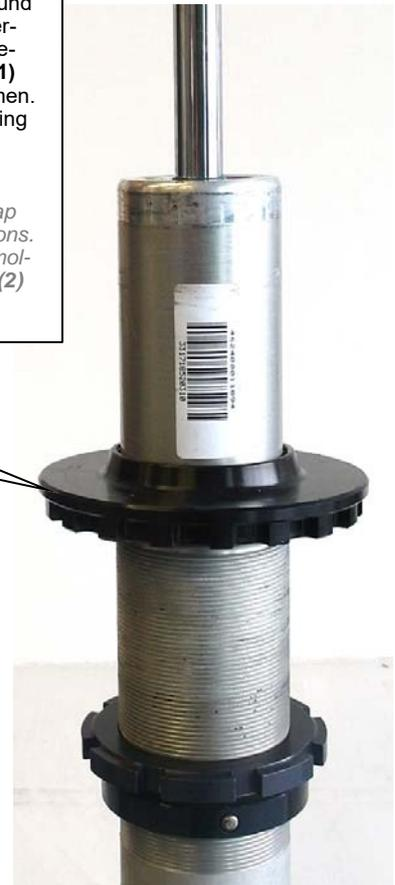
Demontage Sicherungsring: Madenschraube einsägen und mit einem Schraubendreher herausdrehen.
