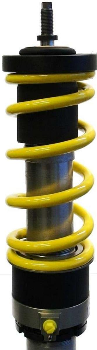
Mitgelieferte Feder und Federteller aufsetzen. Die Seite am Federteller mit dem Radius muss zum Stützlager zeigen!
