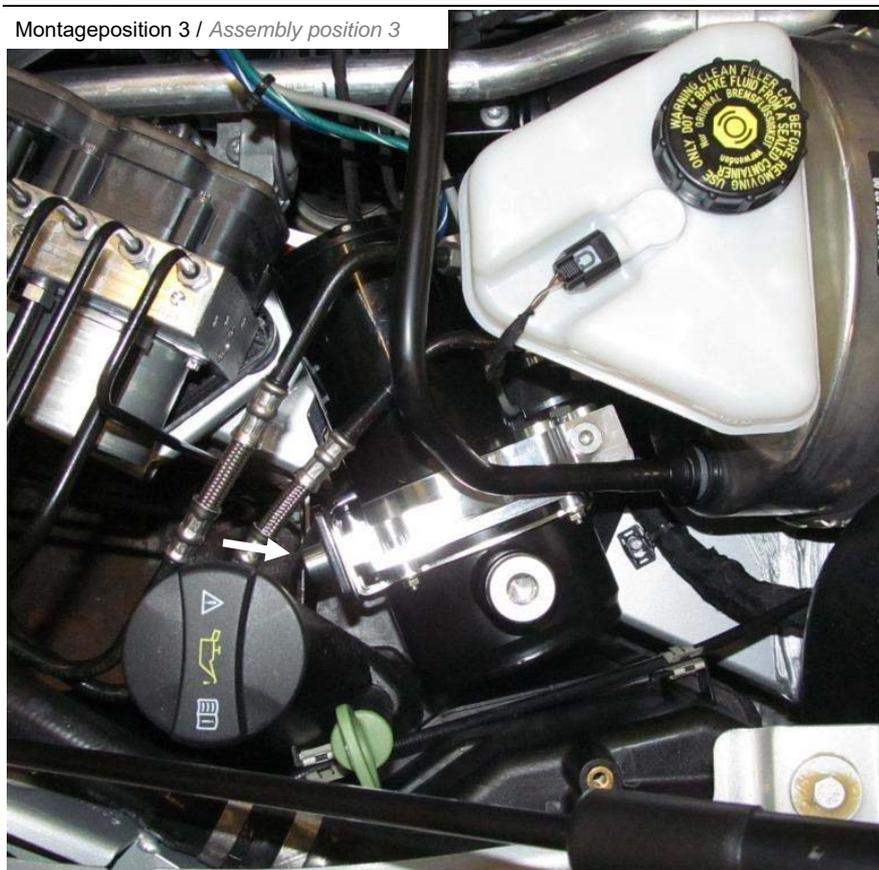
Hydraulikpumpe mit den Schrauben M10x20 an den Halter montieren.
