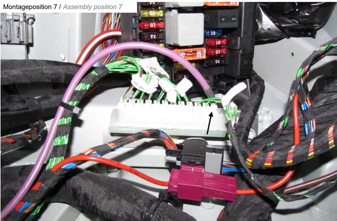
**Anschluss Innenraumtaster / *Connection of the Interior button***
