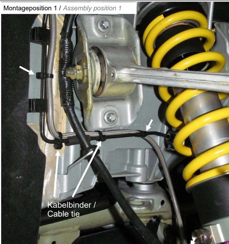
Hydraulikleitung entlang der Bremsleitung verlegen und mit Kabelbinder befestigen. Kabelbinder erst nach vollständiger Leitungsverlegung festziehen.
