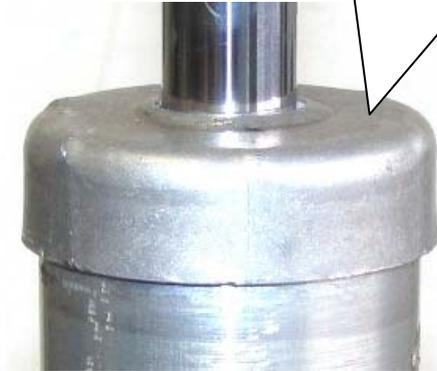
Anschlagelement mit geändertem Staubschutzrohr auf den Dämpfer aufstecken. Originale Stützscheibe wieder auf die Kolbenstange aufstecken.
