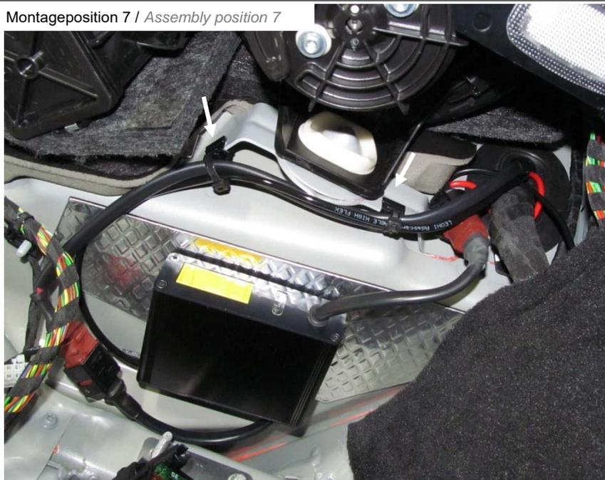
Leitungen mit Edge Clips an der Kante befestigen.
