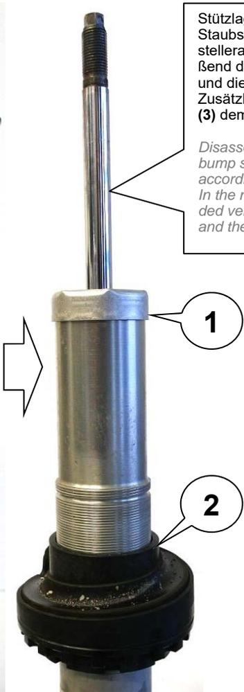
Stützlager, Feder, Anschlagelament und Staubschutz vom Federbein nach Herstellerangaben demontieren. Anschließend die aufgepresste Staubkappe (1) und die Gummiunterlage (2) entnehmen. Zusätzlich muss der obere Gewinding (3) demontiert werden.
