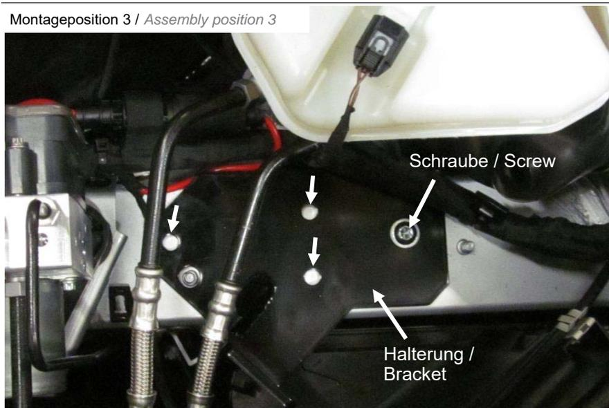
Halterung für die Pumpe im Motorraum mit einer Schraube M8x25 an der vorhandenen Einnietmutter montieren. Restliche 3 Bohrungen markieren.
