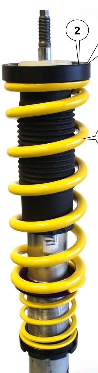
Mitgelieferte Feder **(1)** und Federteller **(2)** aufsetzen. Die Seite am Federteller mit dem Radius muss zum Stützlager zeigen!
