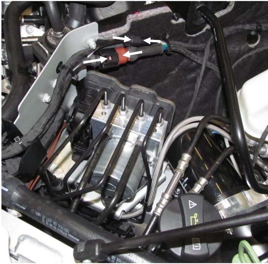
Stromversorgungsleitung der Hydraulikpumpe und die Zuleitung für das Magnetventil mit den Leitungen an der Pumpe verbinden.
