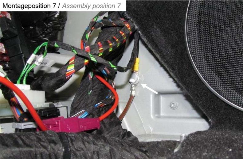
Masseleitung am Massepunkt an der A-Säule montieren.
