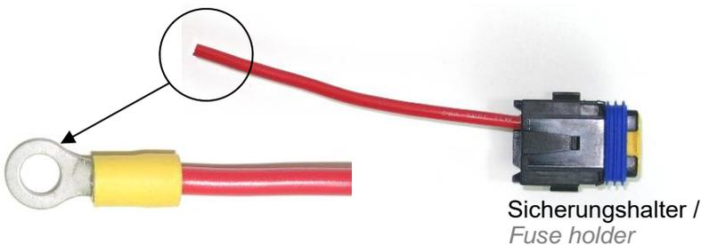
Plusleitung (rot) am Sicherungshalter 8 mm abisolieren und mitgelieferten Kabelschuh mit geeignetem Werkzeug montieren.
