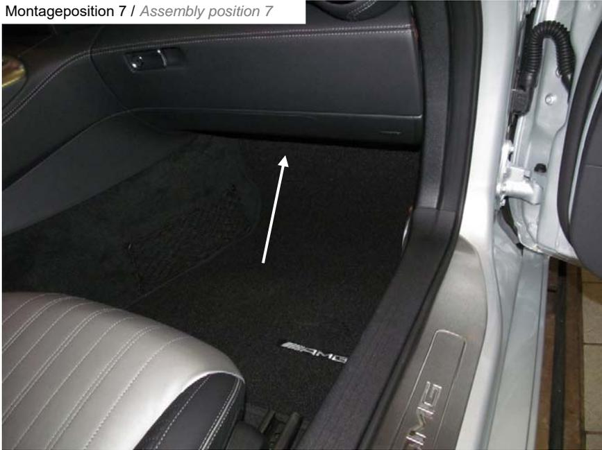
Das HLS Steuergerät wird unter dem Handschuhfach montiert. Hierzu muss die untere Abdeckung und die Fußstütze demontiert werden.
