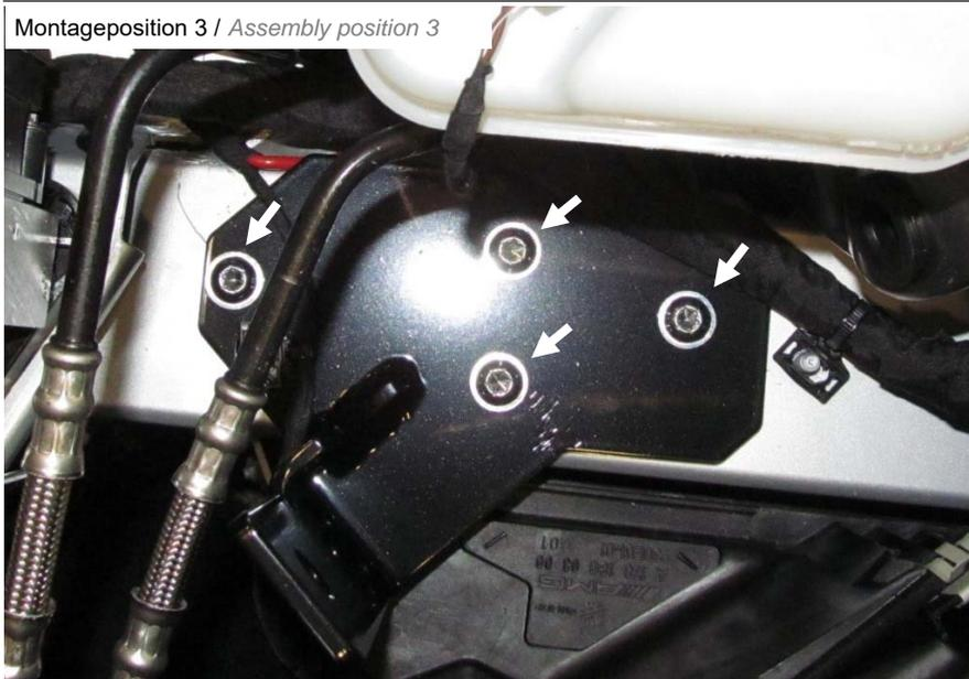
Halterung mit den mitgelieferten Schrauben M8x25 am Fahrzeugrahmen montieren.
