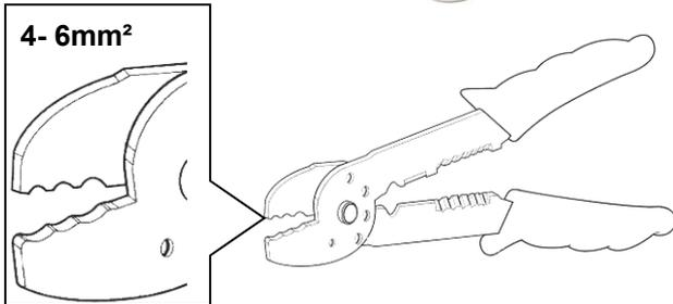
Masseleitung (blau) 8 mm abisolieren und mitgelieferten Kabelschuh mit geeignetem Werkzeug an der Masseleitung (blau) montieren.
