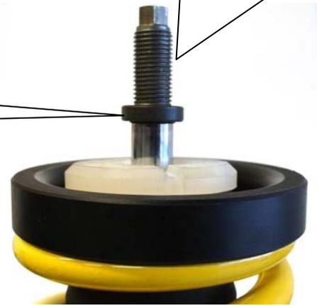
Originale Stützlagereinheit ohne serienmäßige Gummiunterlage auf die Feder aufsetzen und mit der mitgelieferten Stopmmutter verschrauben. Die Montagehinweise zum Einbau des Federbeines in das Fahrzeug, sowie die Anzugsdrehmomente der Federbeinbefestigung, entnehmen Sie bitte den Unterlagen des Fahrzeugherstellers.
