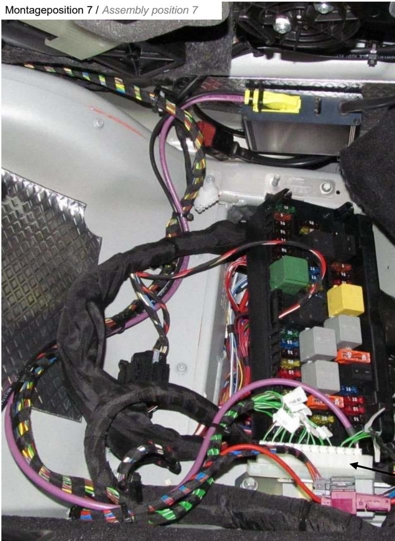
Mitgelieferte CAN Leitung in das HLS Steuergerät einstecken und Stecker verriegeln. Das andere Ende der CAN Leitung in den serienmäßigen CAN Verteiler einstecken. Leitung mit Kabelbindern am Kabelbaum befestigen.
