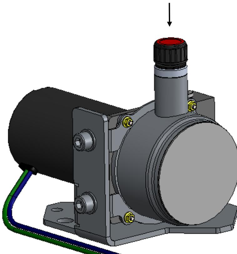
Mitgeliefertes Hydrauliköl bis zur Markierung am Ölmesstab einfüllen.
