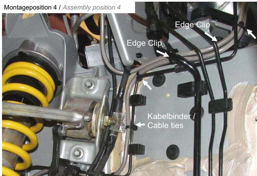
Hydraulikleitung (1100 mm) zur Hydraulikpumpe verlegen.
