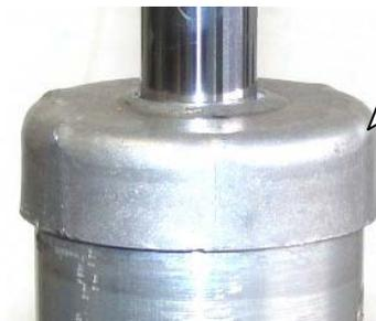
Vorspannfeder (1), Zwischenring (2) und das originale Anschlagel­ement mit Staub­schutzrohr (3) aufstecken.
