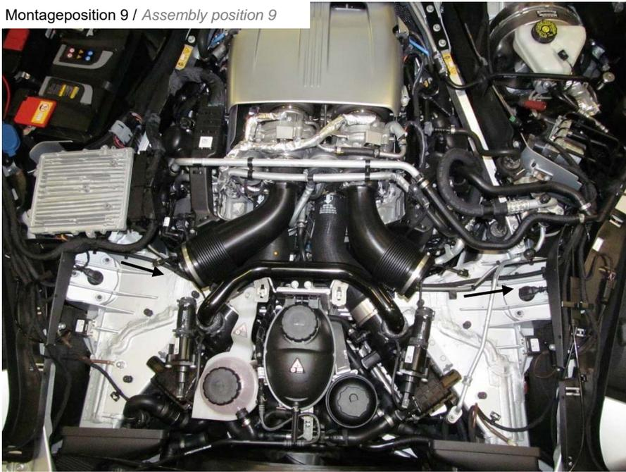
Die Zuleitung für das Magnetventil sowie die Zuleitung für die Hydraulikpumpe entlang der Hydraulikleitung zur Pumpe verlegen. Umwickelte Leitung mit Kabelbindern an der Hydraulikleitung und an der Bremsleitung befestigen.
