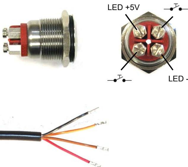
Leitungen an den Verschraubungen montieren.
