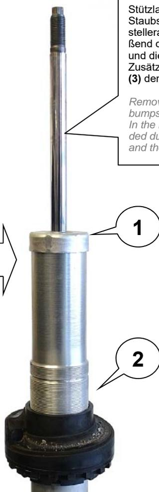
Stützlager, Feder, Anschlagelament und Staubschutz vom Federbein nach Herstellerangaben demontieren. Anschließend die aufgespreste Staubkappe (1) und die Gummiunterlage (2) entnehmen. Zusätzlich muss der obere Gewinding (3) demontiert werden.
