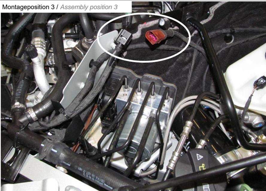
Mitgelieferte Stecker an die Leitung montieren. Hierzu Leitung mit Abdichtungen in das Gehäuse ganz einschieben und einrasten. Anschließend Steckergehäuse verriegeln!
