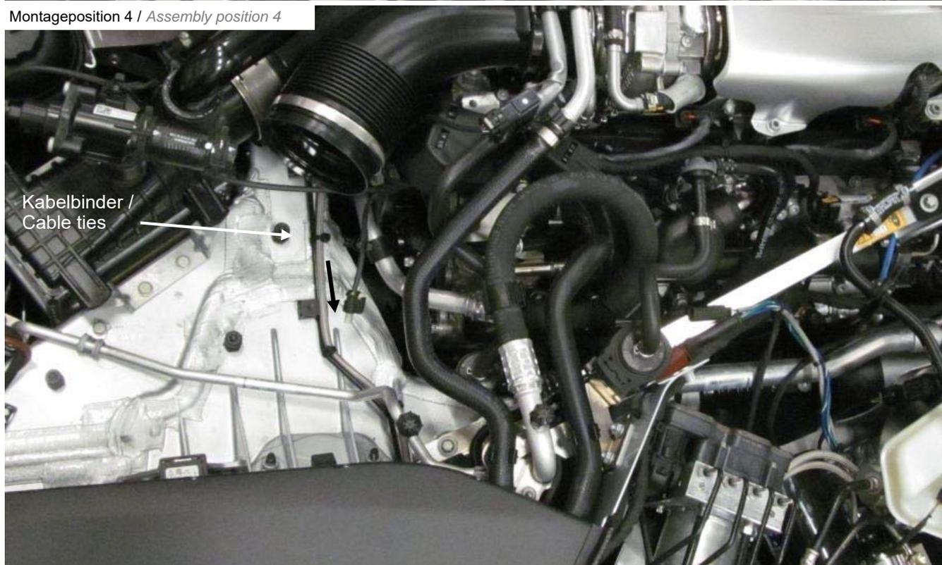
Hydraulikleitung, wie im Bild zu sehen, zur Hydraulikpumpe verlegen und mit Kabelbindern und Edge Clips befestigen.
