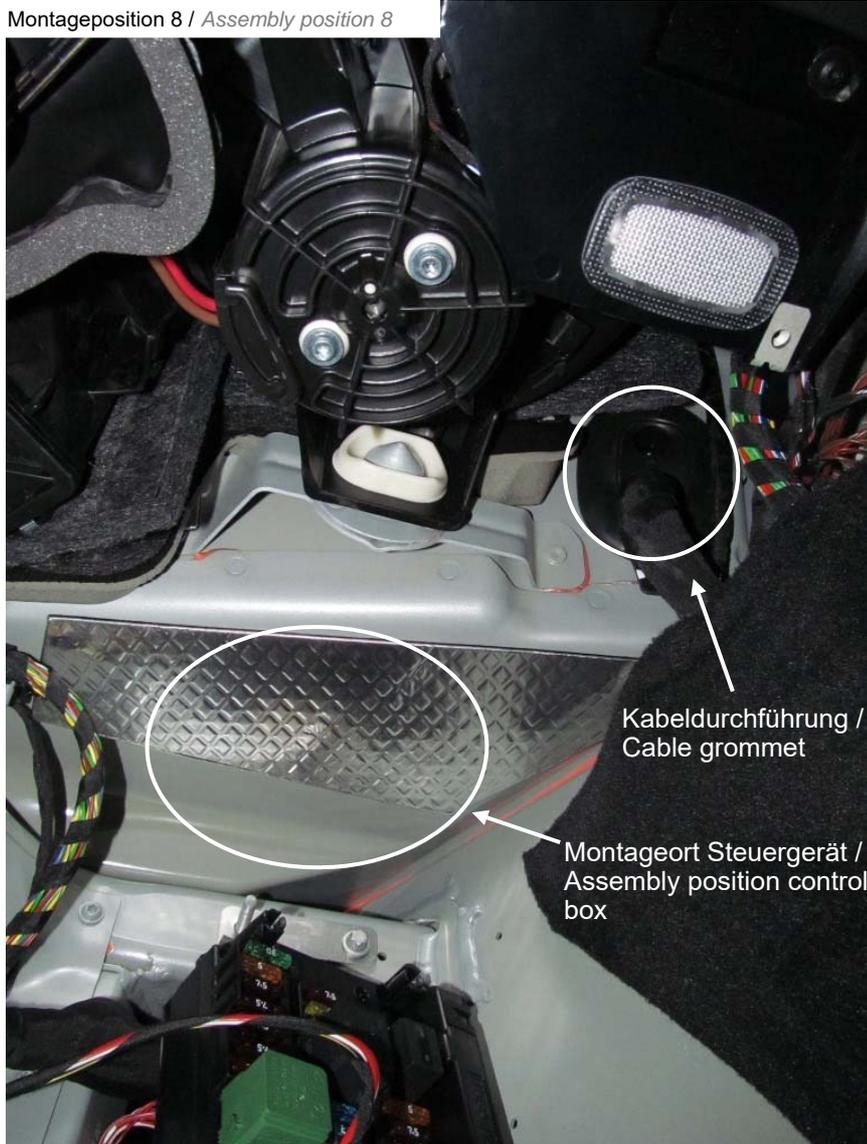
Steuergerät an der markierten Stelle mit Klettband befestigen. Klebefläche zuvor gründlich reinigen. Dieses muss Staub- und Fettfrei sein.
