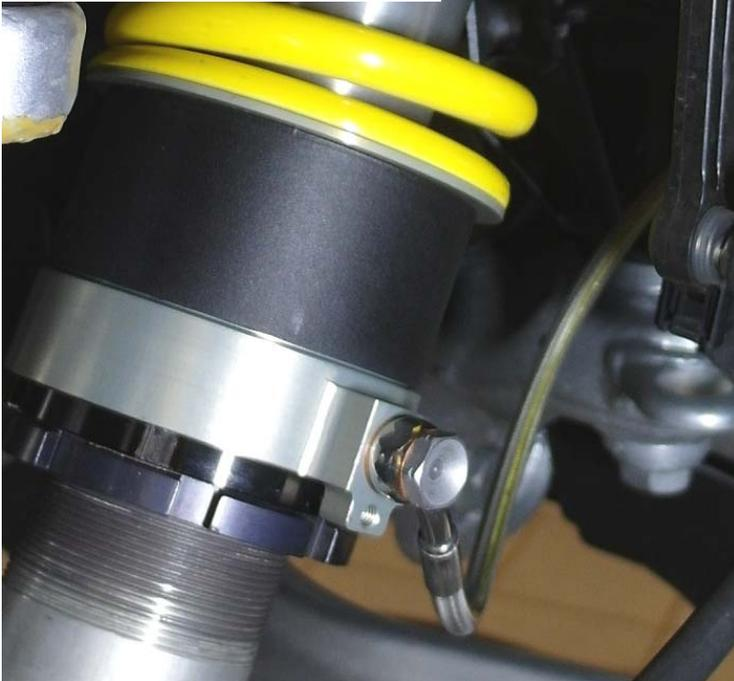
Hydraulikleitung (1100 mm) am HLS Ringzylinder mit der mitgelieferten Hohlschraube und 2 Dichtscheiben montieren.
