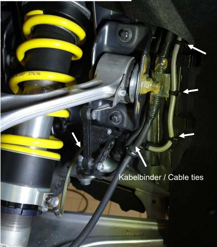
Hydraulikleitung entlang der Bremsleitung verlegen und mit Kabelbinder befestigen. Kabelbinder erst nach vollständiger Leitungsverlegung festziehen
