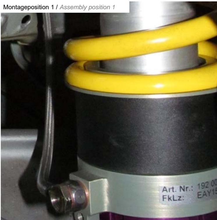
Hydraulikleitung (2700 mm) am HLS Ringzylinder mit der mitgelieferten Hohl-schraube und 2 Dichtscheiben montieren.
