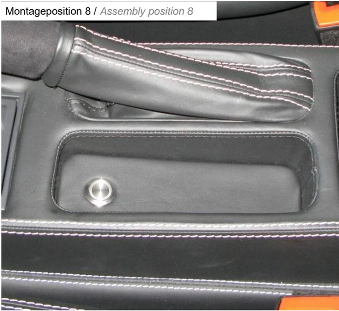
Für die Montage des Tasters muss ein Loch in die Ablage gebohrt werden.
