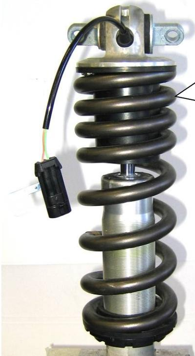
Federn des Original Federbein demontieren. Hierzu muss der Gewinding nach unten herunter gedreht werden. Gewinde vor der Demontage gründlich reinigen.
