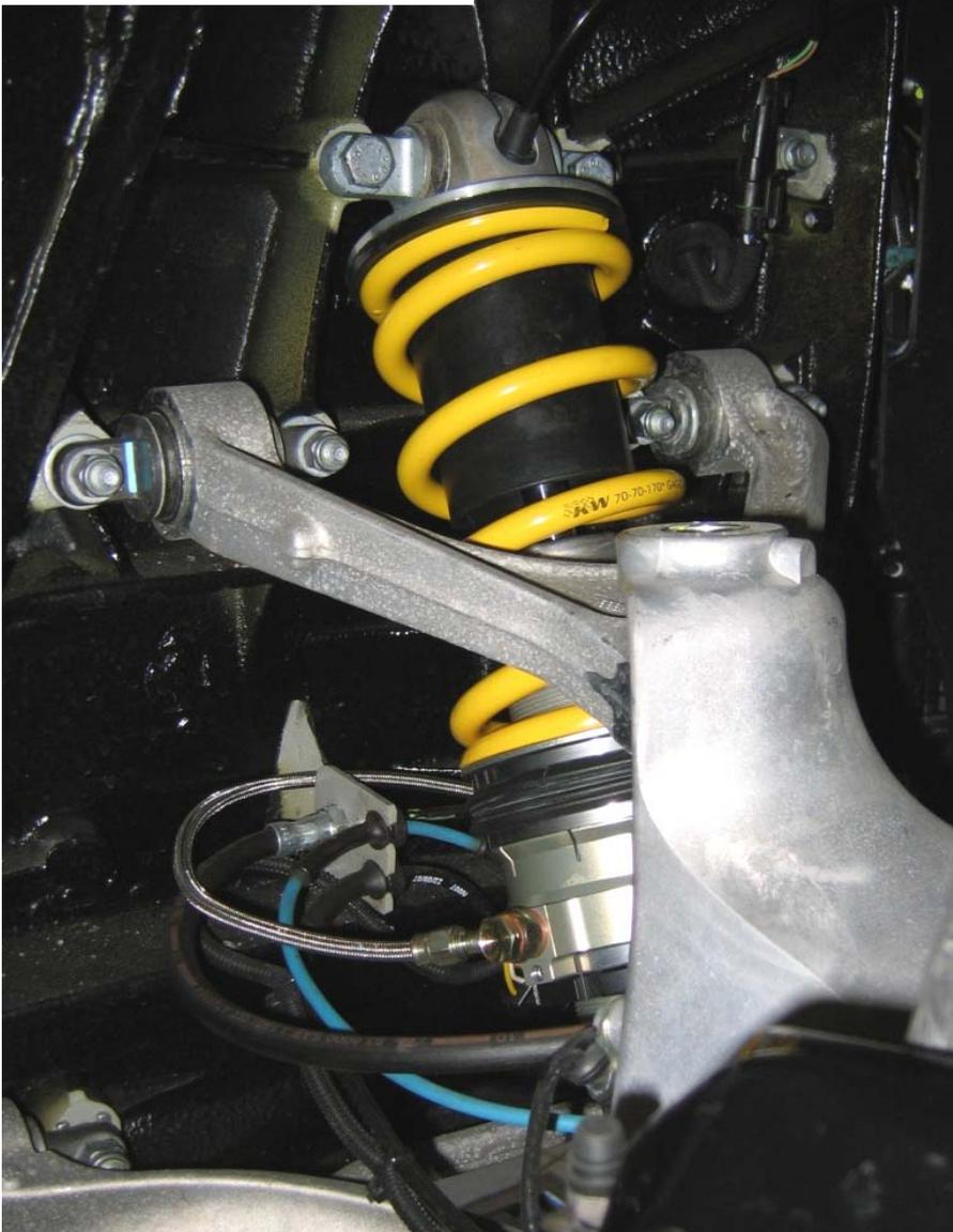
Hydraulikleitung (1000 mm) am HLS Ringzylinder mit der mitgelieferten Hohlschraube und 2 Dichtscheiben montieren.
