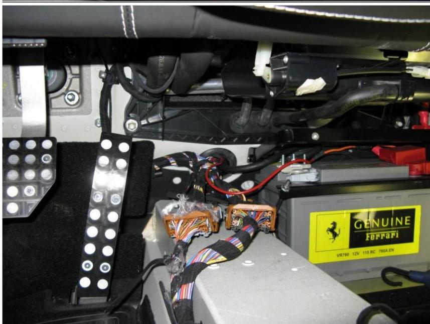
Mittelkonsole demontieren und Tasteranschlussleitung in den Innenraum verlegen.
