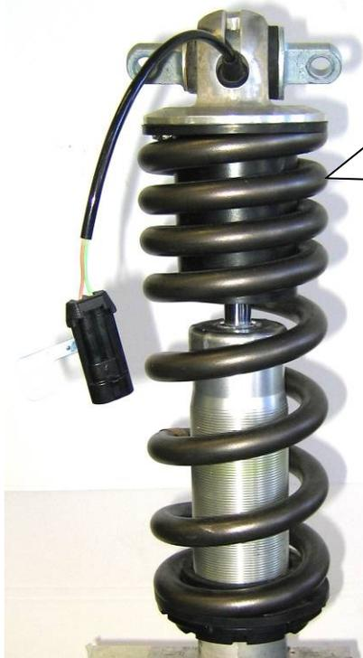
Feder des Original Federbein demontieren. Hierzu muss der Gewinding nach unten herunter gedreht werden. Gewinde vor der Demontage gründlich reinigen.
