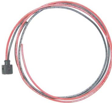
Spannungsversorgungsleitung mit dem Hydraulikaggregat verbinden und auf entsprechende Länge kürzen. Plusleitung wird direkt an der Batterie (mit Sicherung) und die Masseleitung an einem zentralen Massepunkt angeschlossen.
