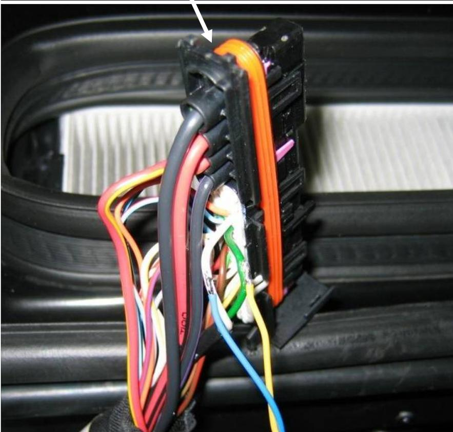
Leitungen des mitgelieferten CAN Steuergeräts an den Original ABS Stecker seitlich anlöten.
