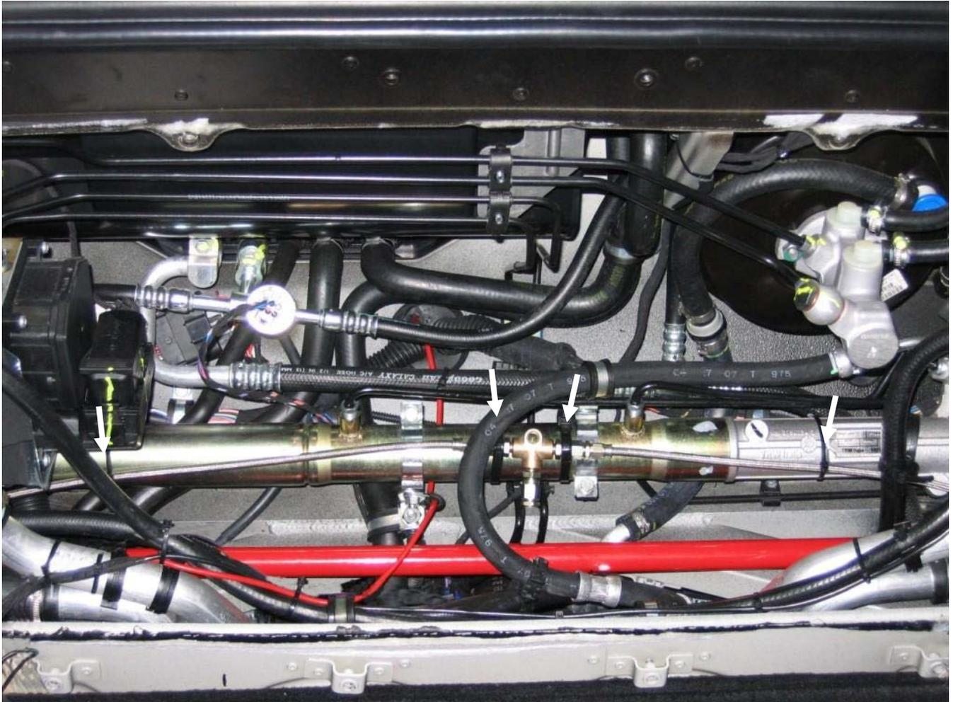
**Verlegung der Hydraulikleitung von dem Verteiler zum Hydraulikaggregat /
