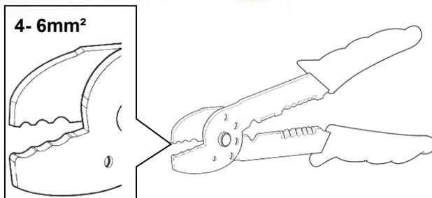
Masseleitung (schwarz) 8 mm abisolieren und mitgelieferten Kabelschuh mit geeignetem Werkzeug an der Masseleitung (blau) montieren.
