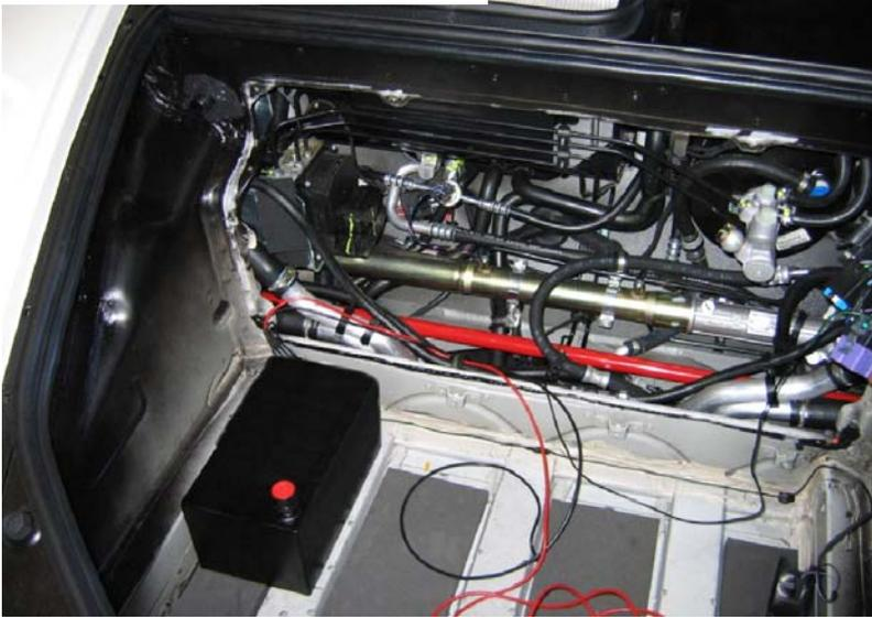
Innenraumteppich entfernen und Hydraulikaggregat positionieren.
