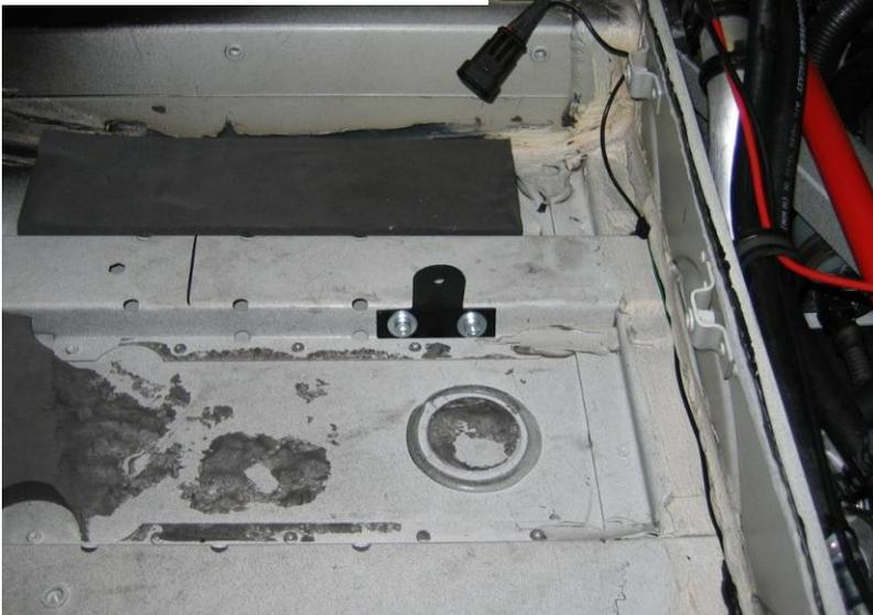
Montagehalter mit den mitgelieferten Blindnietmutter und Torxschrauben M6x16 montieren.
