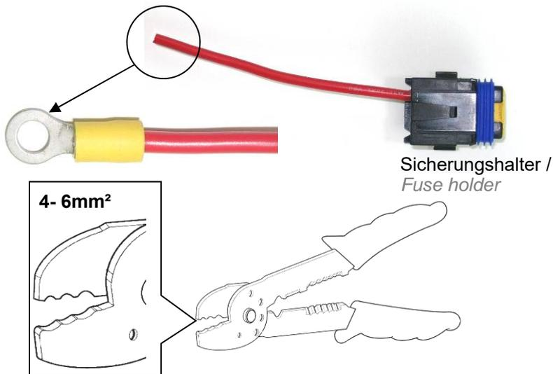
Plusleitung (rot) 8 mm abisolieren und mitgelieferten Kabelschuh mit geeignetem Werkzeug an der Plusleitung (rot) montieren.
