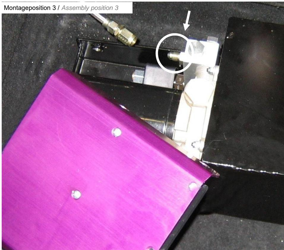
Abdeckung des Hydraulikaggregats demontieren.
