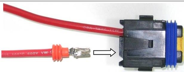
Fertig montierte Plusleitung in den Sicherungshalter einrasten.
