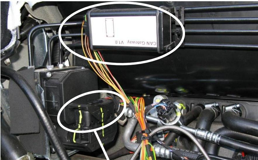
Mitgeliefertes CAN Steuergerät an den Bremsleitungen mit Kabelbinder befestigen.
