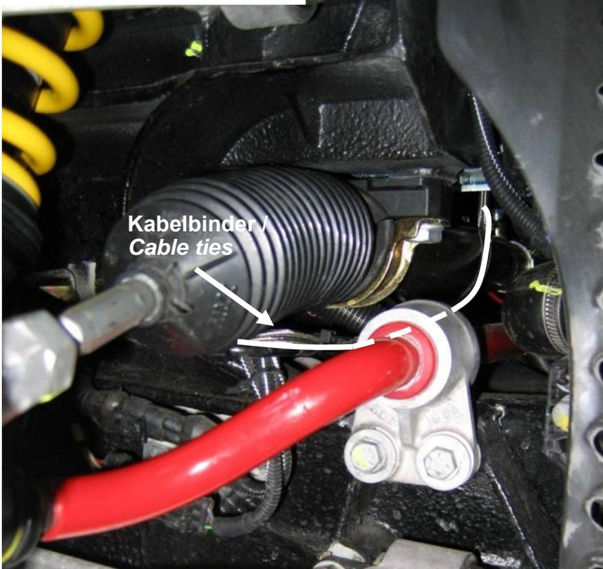
Hydraulikleitung mit Kabelbinder entlang Servolenkung verlegen. Kabelbinder erst nach vollständiger Leitungsverlegung festziehen.
