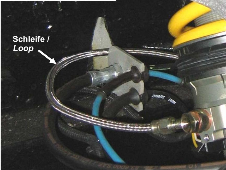
Hydraulikleitung hinter dem Bremsleitungshalter verlegen.
