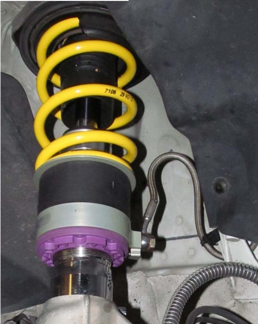
Hydraulikleitung (1300 mm) am HLS Ringzylinder mit der mitgelieferten Hohlschraube und 2 Dichtscheiben montieren.
