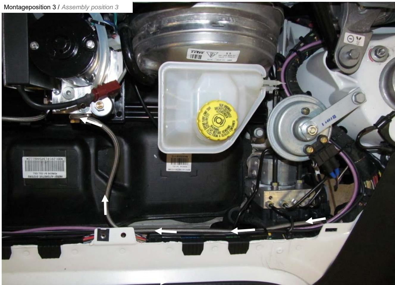
Hydraulikleitung (linke Seite) am Hydraulikaggregat mit der mitgelieferten Hohlschraube und 2 Dichtscheiben montieren.
