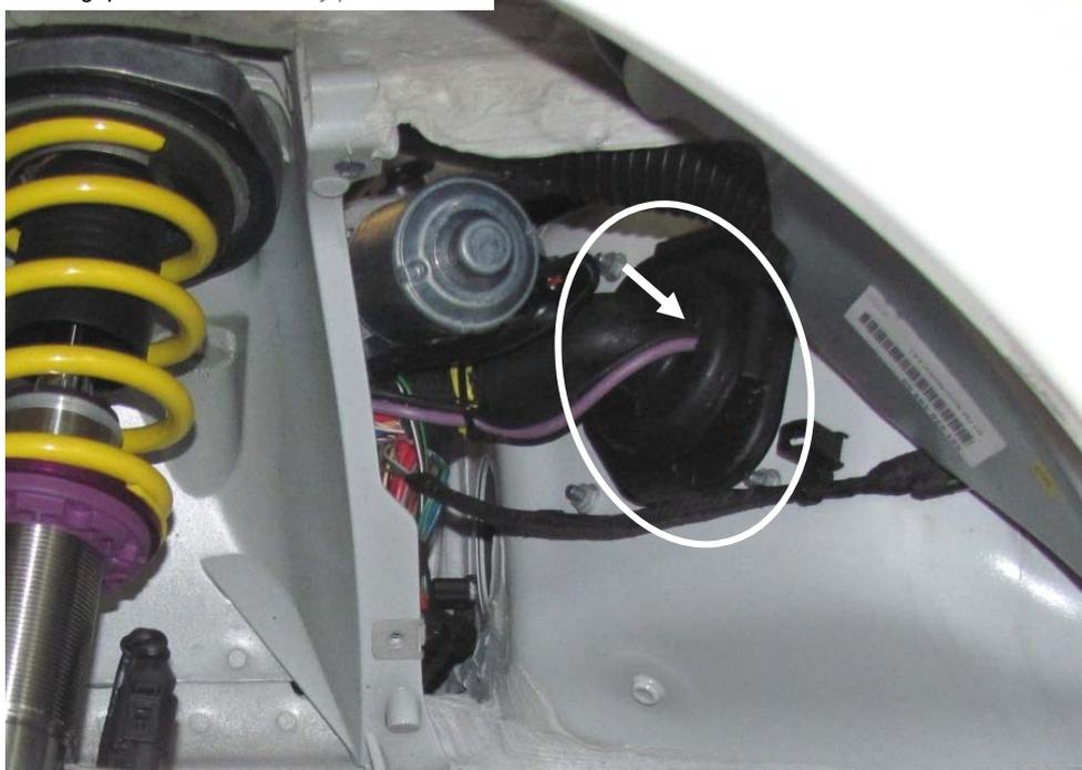
CAN Leitung in den Fahrzeuginnenraum verlegen. Hierzu muss an der Original Kabeldurchführung eine Öffnung eingeschnitten werden. Nach der kompletten Montage muss die Öffnung mit Karosserikleber abgedichtet werden.
