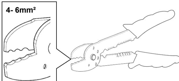
Anschlussleitung bei Bedarf kürzen. Masseleitung (blau) 8 mm abisolieren und mitgelieferten Kabelschuh mit geeignetem Werkzeug an der Masseleitung (blau) montieren. Anschließend Masseleitung am Massepunkt befestigen.
