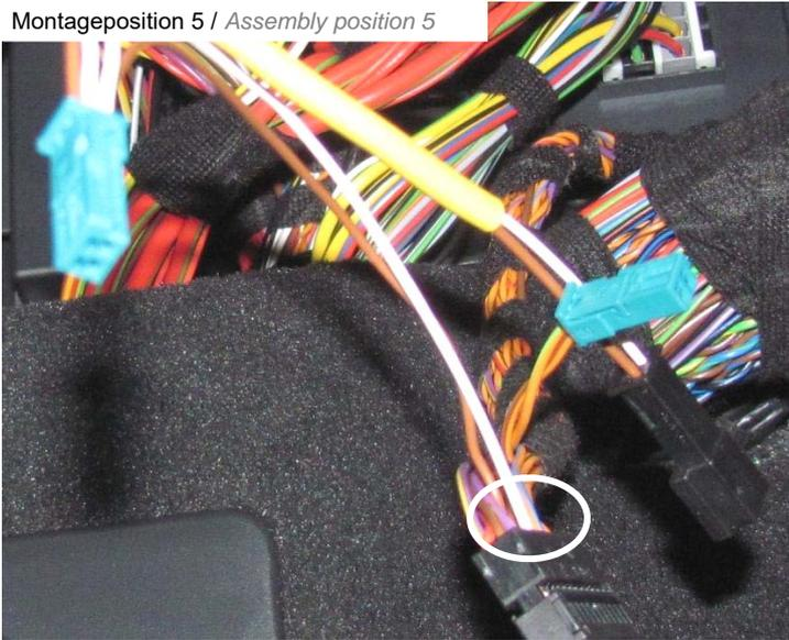
Anschließend die vom Y-Adapter abgehenden Kabel **Pin 1 (weiß)** und **Pin 2 (braun)** in den Originalstecker einstecken.
