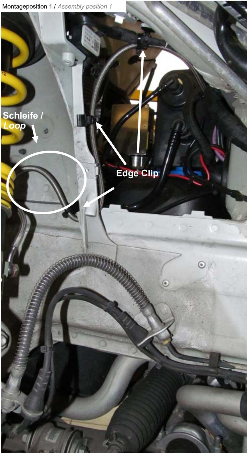
Hydraulikleitung mit Befestigungsbinder Edge Clips entlang der Karosseriekannte verlegen. Kabelbinder erst nach vollständiger Leitungsverlegung festziehen.
