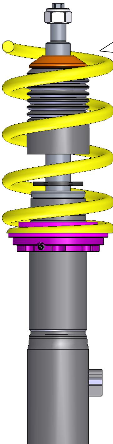
Feder und Anschlagelament mit Faltenbalg vom verbauten Federbein demontieren. Federbein gründlich reinigen.
