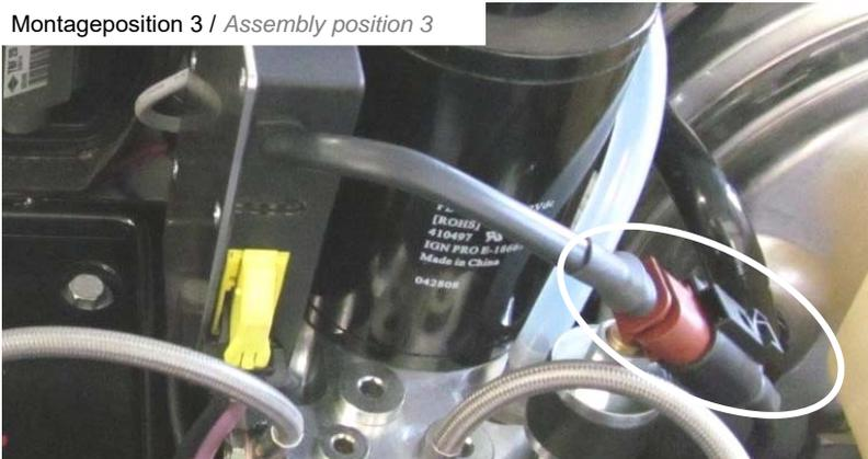
Spannungsversorgungsleitung mit dem Hydraulikaggregat verbinden und auf entsprechende Länge kürzen.
