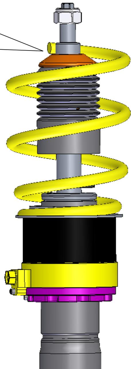
Nach erfolgtem Einbau des Fahrwerkes ist die Freigängigkeit der Bereifung zum VA-Federbein zu überprüfen. Das Mindestabstandsmaß darf an der engsten Stelle **5 mm** nicht unterschreiten und ist gegebenenfalls mittels handelsüblicher, TÜV geprüfter Distanzscheiben wieder herzustellen.
