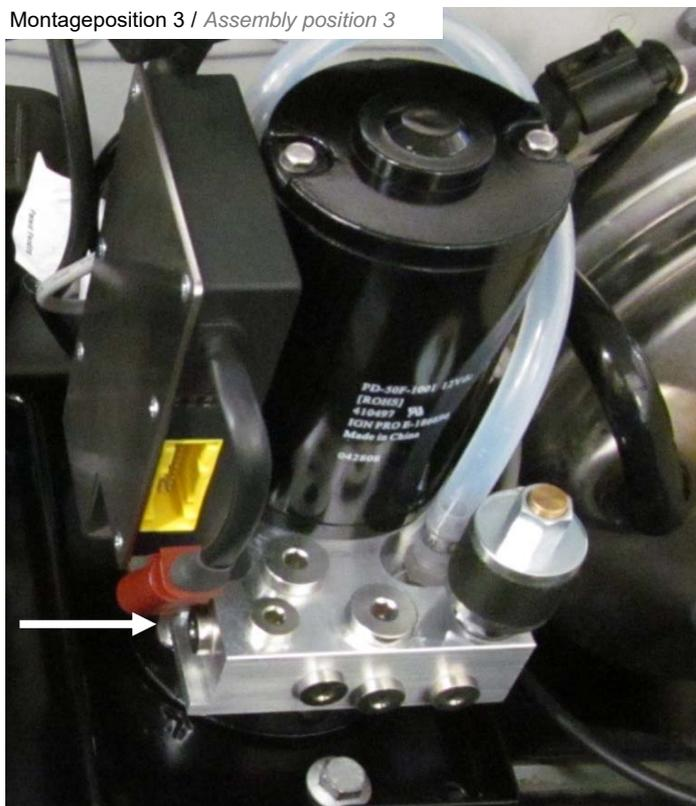
Der Anschluss der Hydraulikleitung kann mit einer Zange und einem Rundmaterial gedreht werden.
