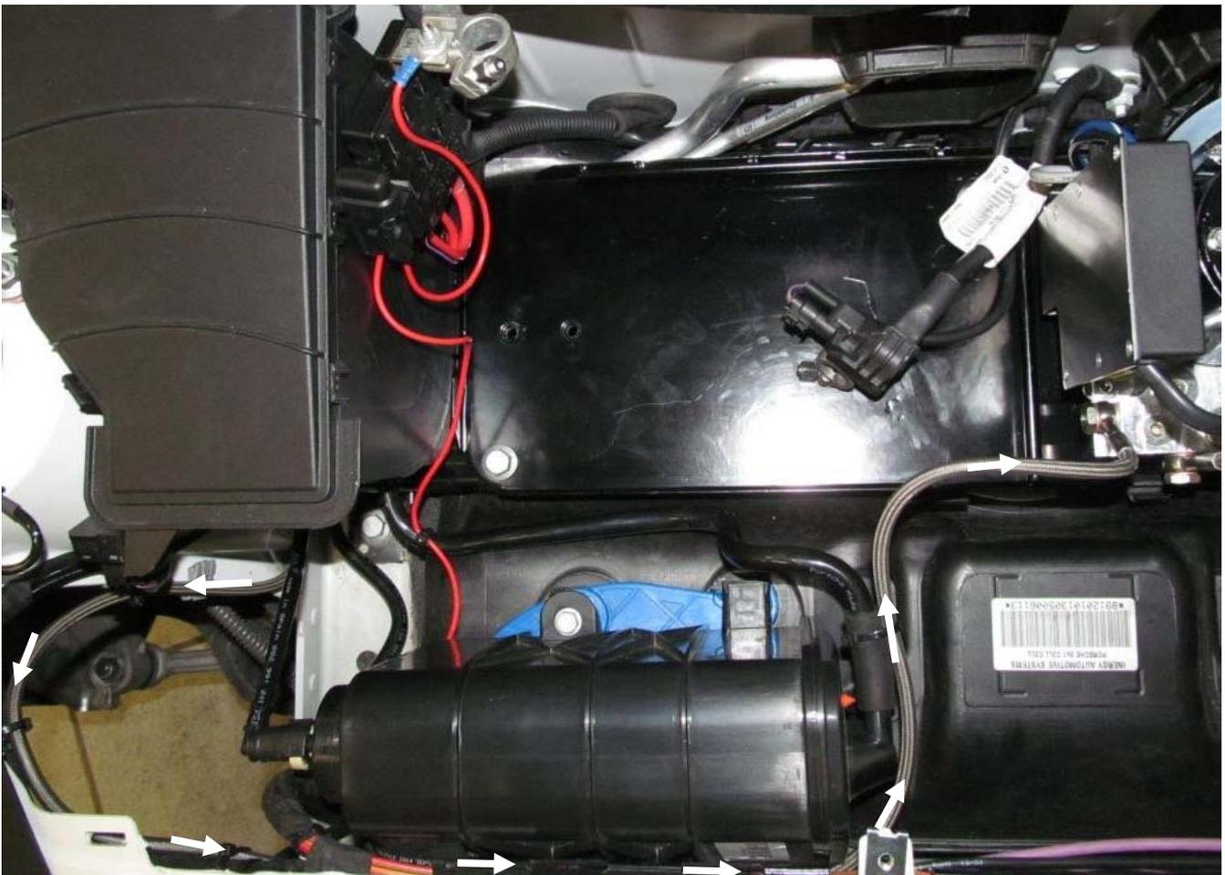
Hydraulikleitung (rechte Seite) am Hydraulikaggregat mit der mitgelieferten Hohlschraube und 2 Dichtscheiben montieren.
