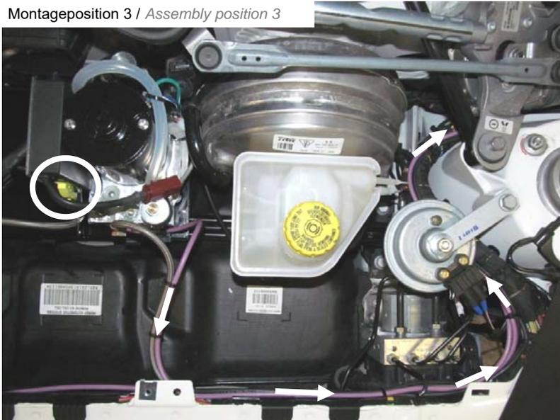
Mitgelieferte CAN Leitung in das HLS Steuergerät einstecken und Stecker verriegeln. CAN Leitung entlang des Kabelbaums in den Fahrzeuginnenraum verlegen.
