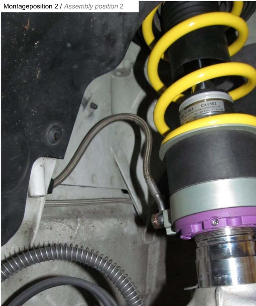
Hydraulikleitung (1300 mm) am HLS Ringzylinder mit der mitgelieferten Hohl-schraube und 2 Dichtscheiben montieren.
